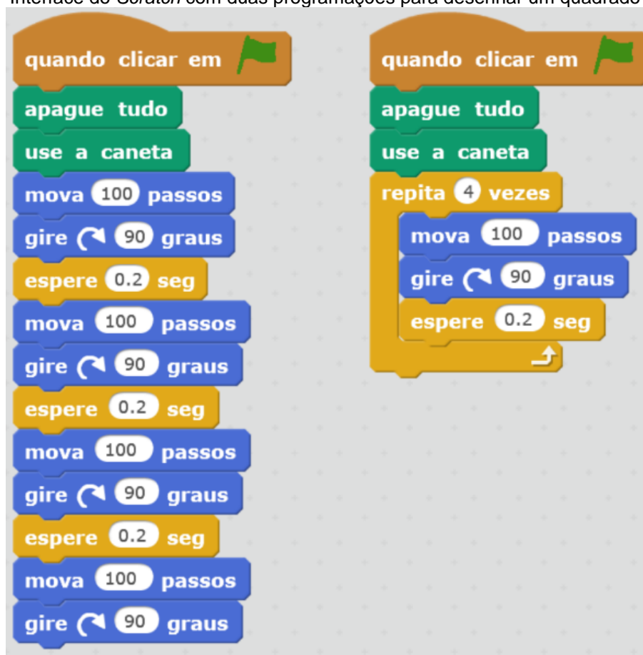
Figura 7 – Interface do Scratch com duas programações para desenhar um quadrado de lado 100
