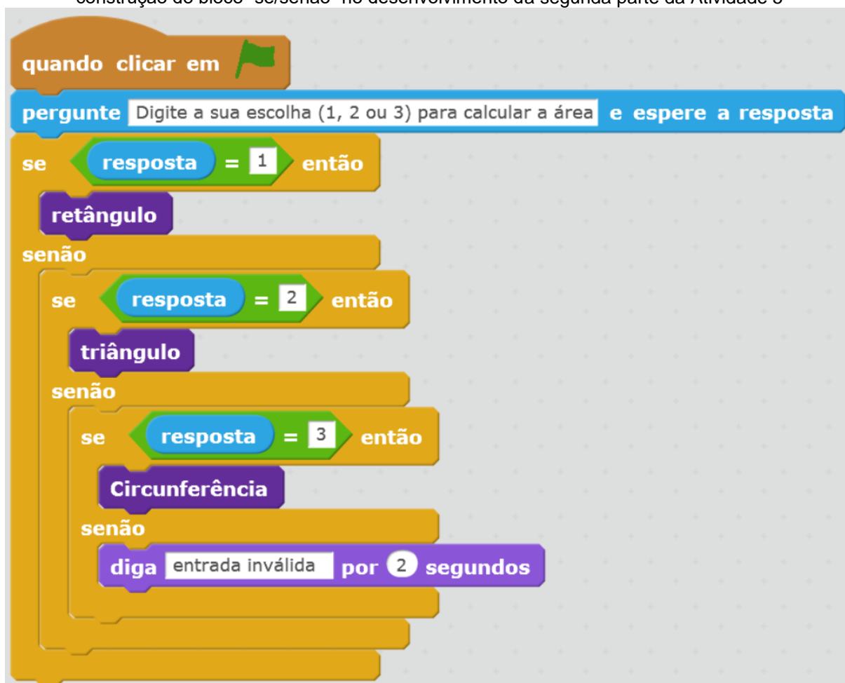
Figura 51 – Programação desenvolvida pelo pesquisador para exemplificar como deveria ser a construção do bloco “se/senão” no desenvolvimento da segunda parte da Atividade 5
