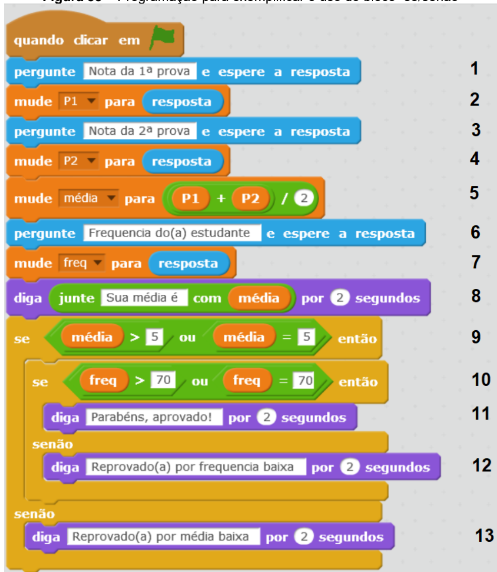
Figura 33 – Programação para exemplificar o uso do bloco “se/senão”
