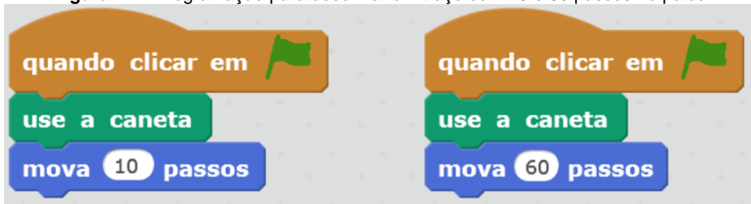
Figura 11 – Programação para desenhar um traço com 10 e 60 passos no palco
