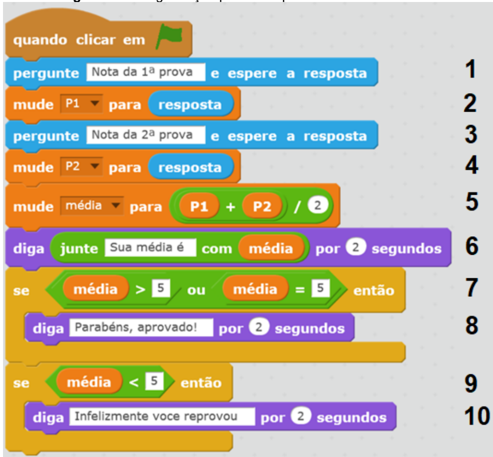
Figura 31 – Programação para exemplificar o uso do bloco “se”
