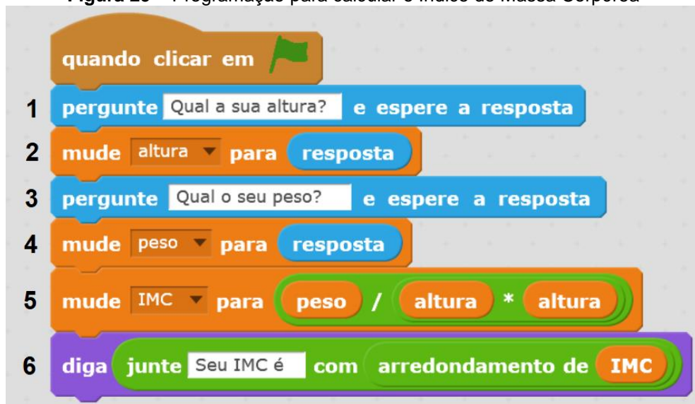
Figura 29 – Programação para calcular o Índice de Massa Corpórea
