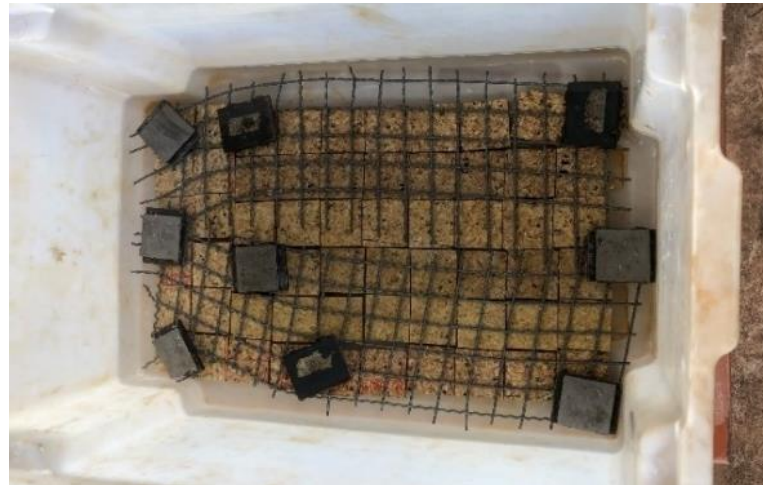
Figura 42 – Ensaio de Inchamento Após 24h
