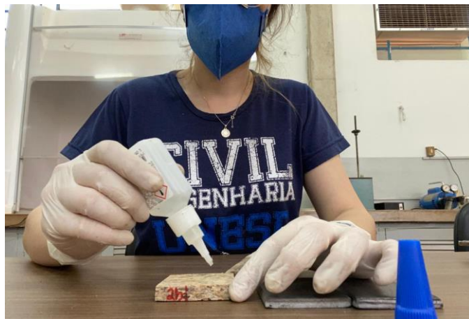
Figura 37 – Colagem dos suportes metálicos nos corpos de prova de madeira
