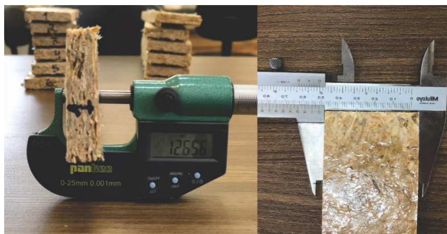
Figura 35 – Aferição das dimensões dos corpos de prova
