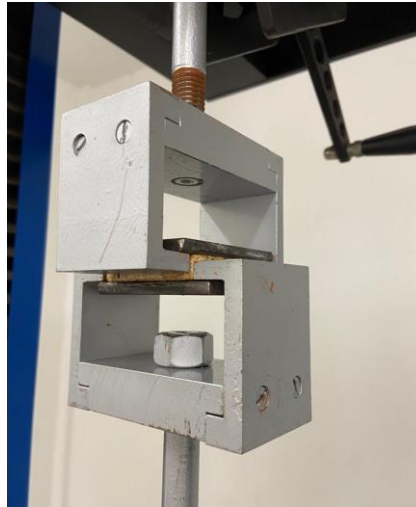
Figura 38 – Colagem dos suportes metálicos nos corpos de prova de madeira
