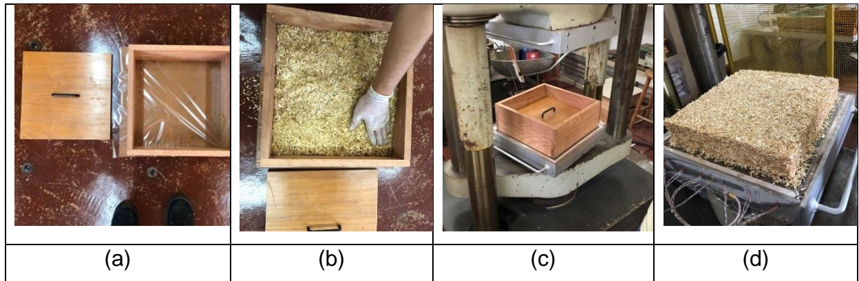
Figura 31 – Formação do colchão de partículas e pré-prensagem
