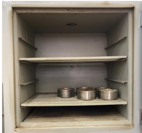
Figura 29 – Amostras das partículas usadas no ensaio de teor de umidade dentro da estufa
