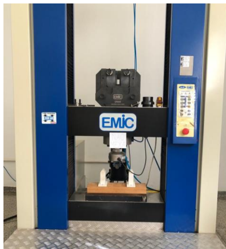
Figura 33 – Máquina Universal de ensaios e o dispositivo para ensaio de flexão estática em corpo de prova de painéis aglomerados.
