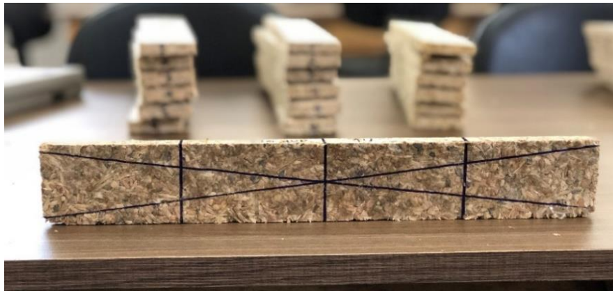
Figura 34 – Corpo de prova do ensaio de flexão com diagonais traçadas.
