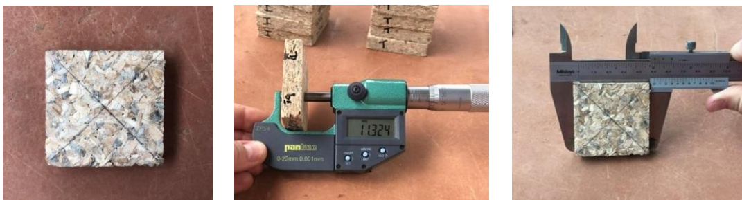
Figura 40 – Aferição das dimensões dos corpos de prova
