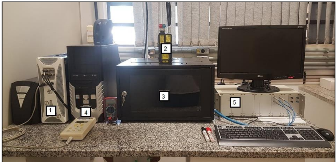
Figura 3 - Configuração experimental do equipamento LIBS utilizado: 1) Fonte do laser; 2) laser; 3) câmara de amostragem; 4) sistema de aquisição de dados; 5) espectrômetros
