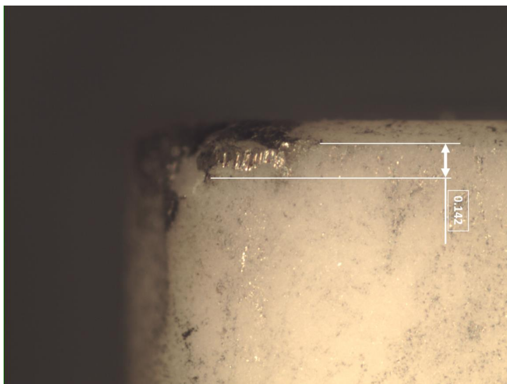
Figura 76 - Desgaste de flanco para V_C = 300 m/min, f = 0,15 mm/rev e a_p = 0,15 mm.
