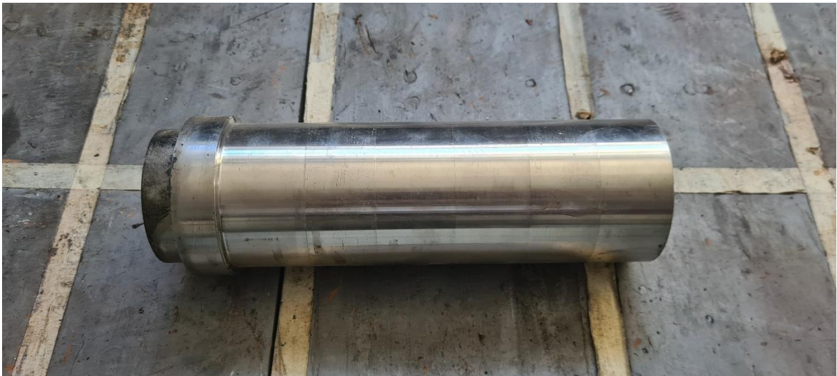
Figura 28 – Corpo de prova utilizado no trabalho com \varnothing 86 mm x 226 mm.
