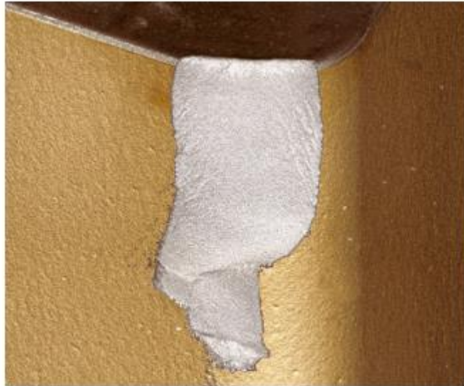
Figura 23 - Quebra de uma ferramenta cerâmica.
