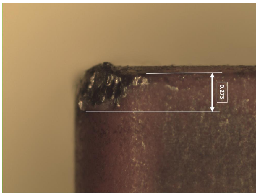
Figura 86 - Desgaste de flanco para V_c = 400 m/min. f = 0,10 mm/rev e a_p = 0,30 mm (ampliação 3x).
