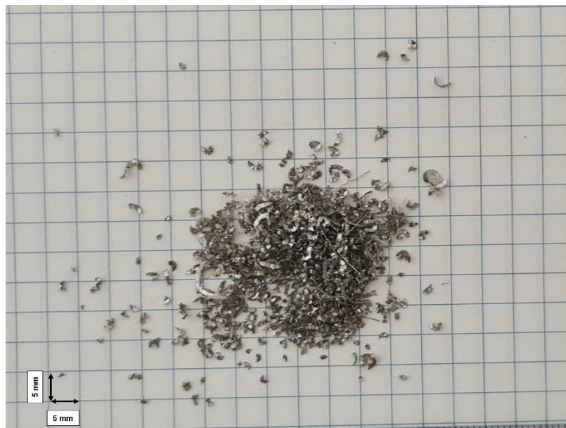
Figura 92 – Cavacos produzidos para V_C = 350 m/min, f = 0,23 mm/rev a_p = 0,23 mm.
