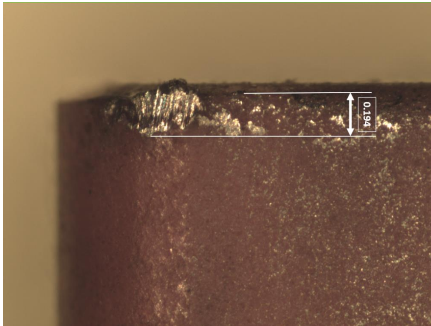
Figura 85 - Desgaste de flanco para V_c = 400 m/min. f = 0,10 mm/rev e a_p = 0,10 mm (ampliação 3x).
