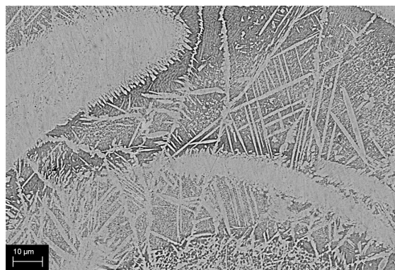
Figura 19 – Microestrutura do cordão em MEV - Amostra Ni50
