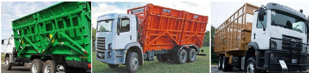
Figura 6 - Novos modelos de veículos de transbordo, montados sobre chassi de caminhão e equipados com rodados duplos e pneus rodoviários de carga
