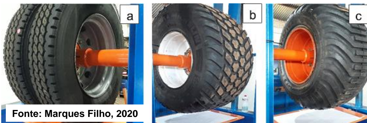
Figura 7 - Pneus utilizados nos ensaios: (a) P1 - 275/80R22.5 (duplo); (b) P2 - 600/50R22.5; (c) P3 - 600/50-22.5
