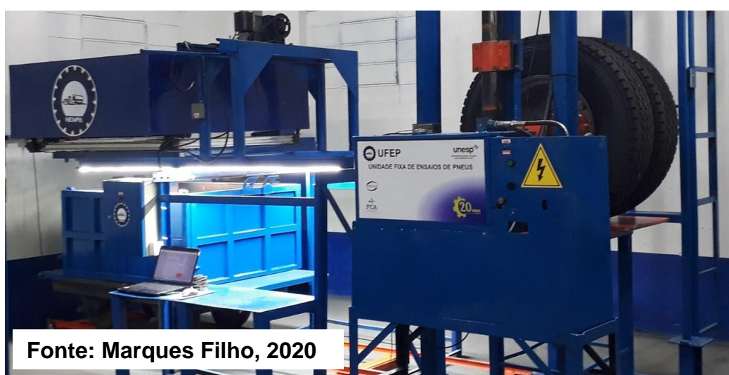
Figura 8 - Unidade Fixa de Ensaio de Pneu
