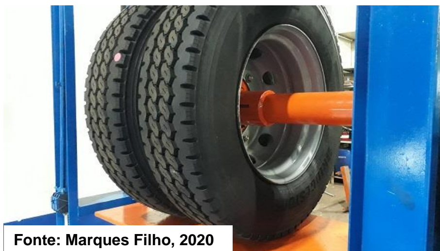
Figura 9 - Rodado montado na UFEP, apoiado sobre a superfície metálica durante os ensaios em superfície rígida (ESR)
