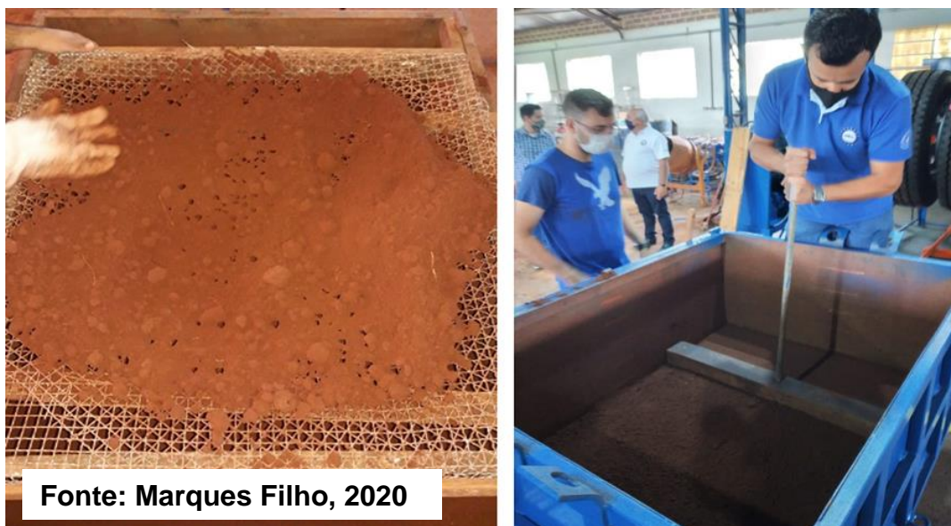
Figura 11 - Montagem manual dos tanques de solo, peneira (esquerda) e sistema de compactação controlada em camadas de solo (direita)
