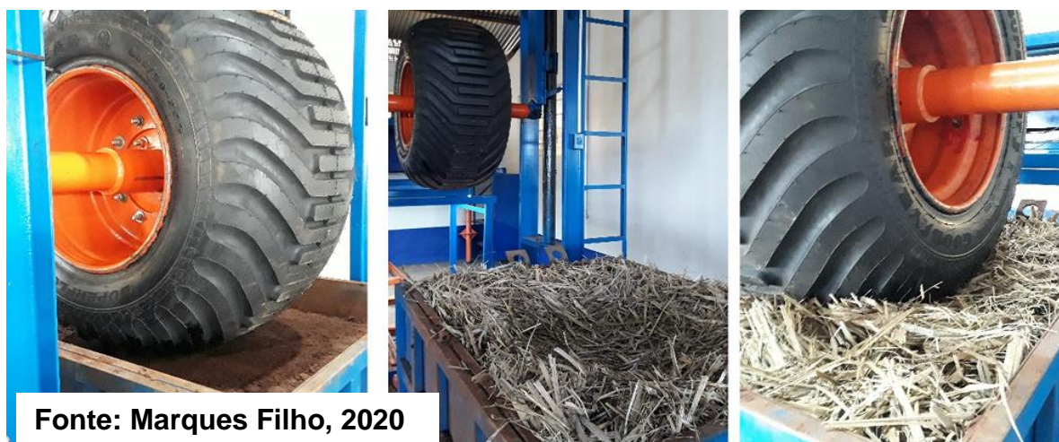
Figura 12 - Montagem dos tanques de solo em diferentes superfícies, sem cobertura (S1) esquerda, com 15\text{Mg ha}^{-1} de palhiço (S2) centro, com 30\text{Mg ha}^{-1} de palhiço de cana-de-açúcar (S3) direita.
