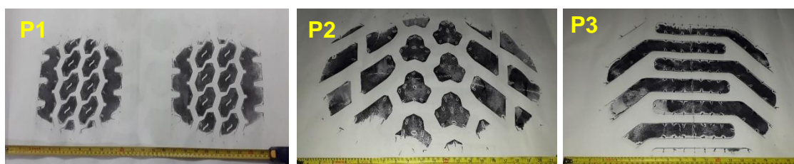
Figura 16 - Área de contato em superfície rígida proporcionada pelos pneus P1 (275/80R22.5-duplo); P2 (600/50-R22.5) e P3 (600/50-22.5) na UFEP
