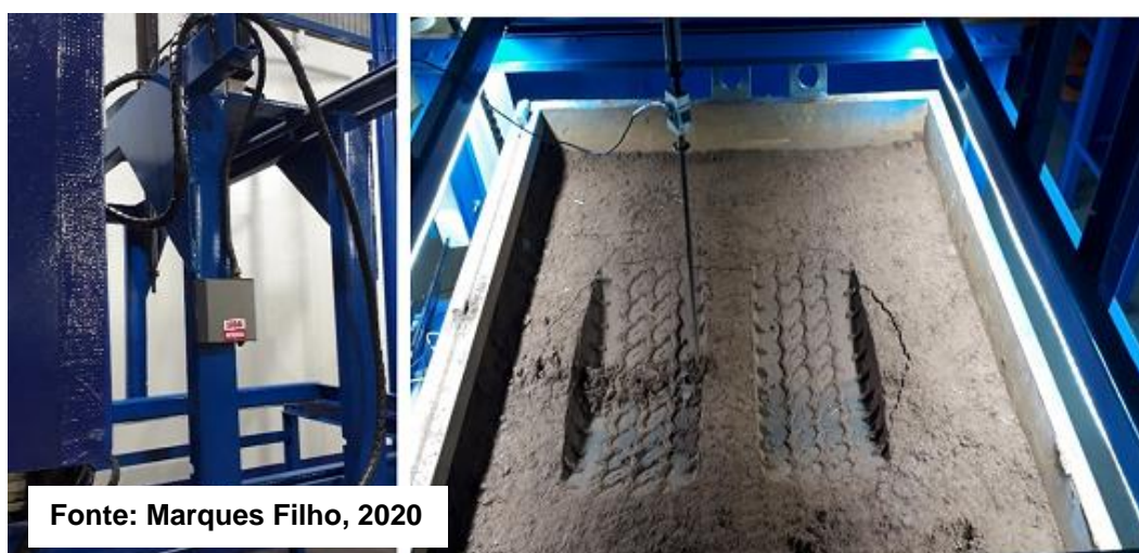
Figura 14 - Penetrômetro utilizado para a coleta dos dados de resistência à penetração do solo
