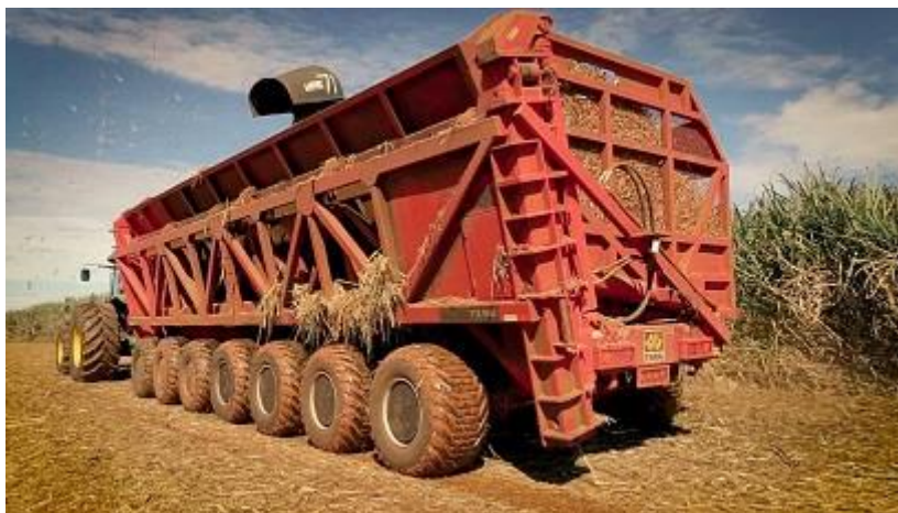
Figura 5 - Veículo de transbordo para colheita da cana-de-açúcar com alta capacidade de carga (45Mg) e 7 eixos direcionais equipados com pneus diagonais
