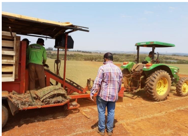
Figura 9 - Colhedora mecanizada acoplada ao trator utilizada na colheita dos tapetes
