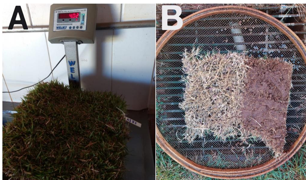
Figura 12 - (a) Pesagem dos tapetes in natura. (b) Tapete parcialmente lavado, para retirada do solo
