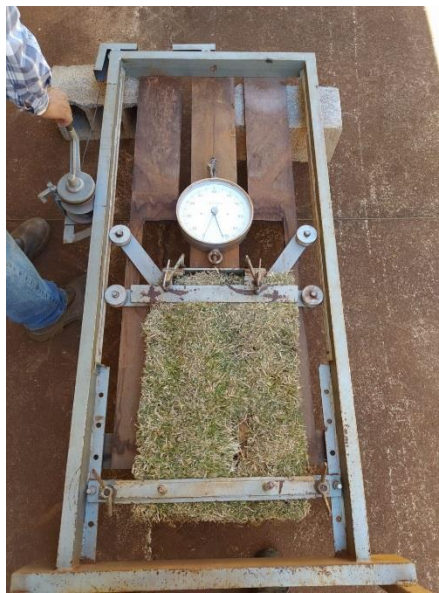
Figura 13 - Aparelho para determinar a resistência mecânica de tapetes de grama
