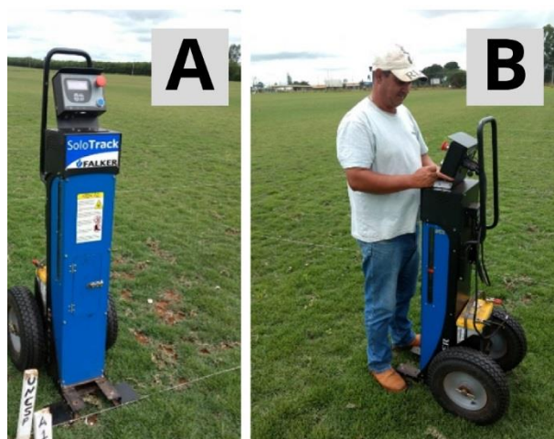
Figura 4 - a) Penetrômetro eletrônico Solo Track 5300 (Falker®). (b) Avaliação de resistência a penetração do solo (RSP)
