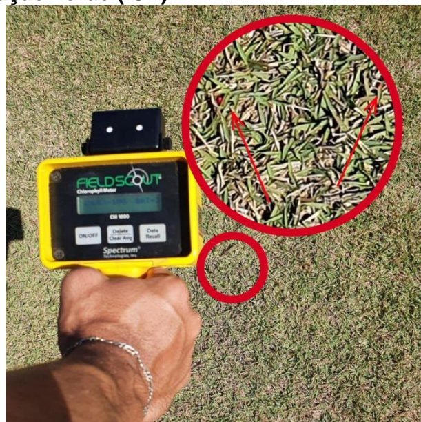
Figura 5 - Equipamento Field Scout CM-1000 utilizado para determinar o índice de coloração verde (ICV)
