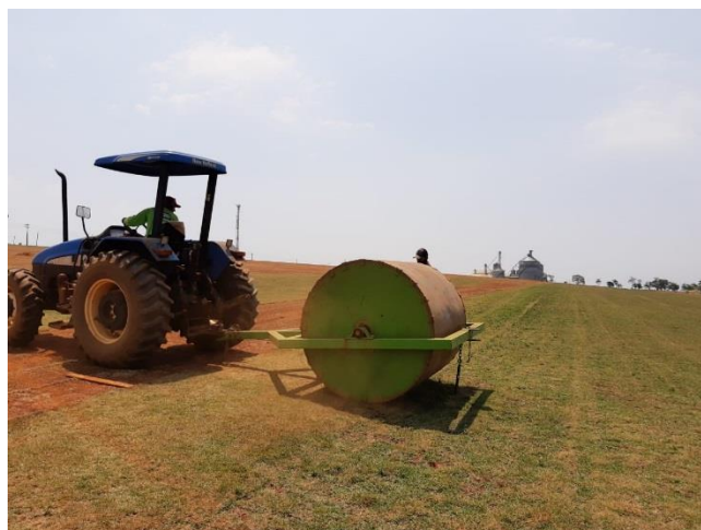
Figura 8 - Passagem do rolo compactador nas parcelas experimentais antes da colheita dos tapetes
