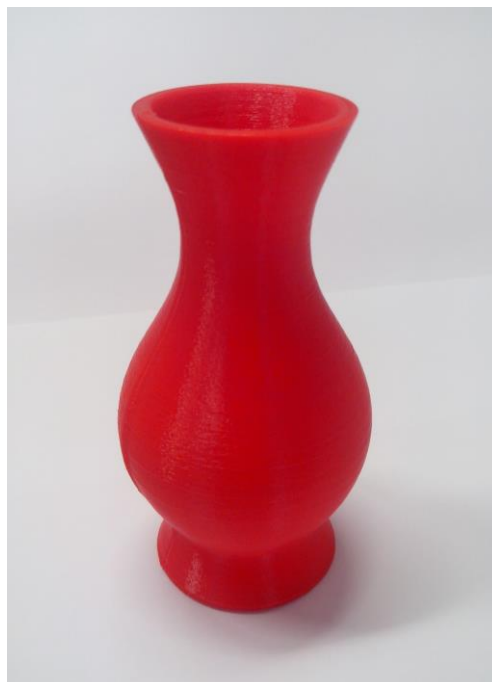
Figura 17: Exemplo de peça impressa em PLA, no CADEP. (Fonte: autora)
