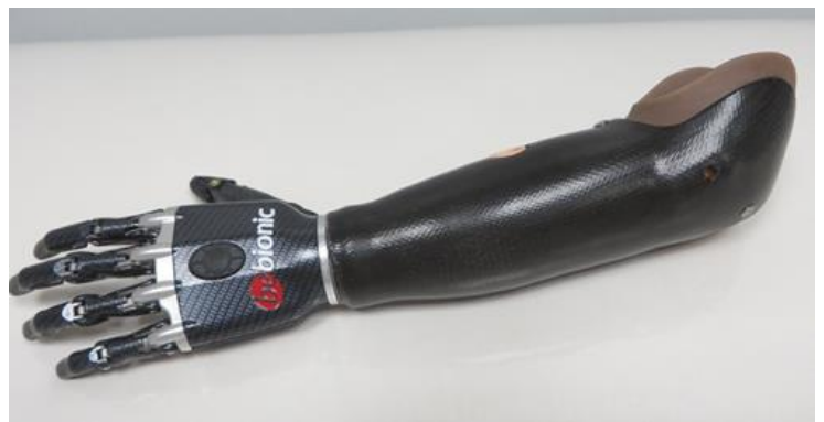
Figura 11: Prótese transradial mioelétrica. (Fonte: http://www.prostheticrehabclinic.co.za/understanding-prosthetics/arm-prostheses/ )
