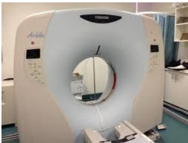
FIGURA 8. EQUIPAMENTO DE TOMOGRAFIA COMPUTADORIZADA MULTISLICE DE 16 CANAIS TOSHIBA ACTIVION (TOSHIBA MEDICAL SYSTEMS, OTAWARA, JAPÃO), (MATERIAL ELABORADO PELO AUTOR).
