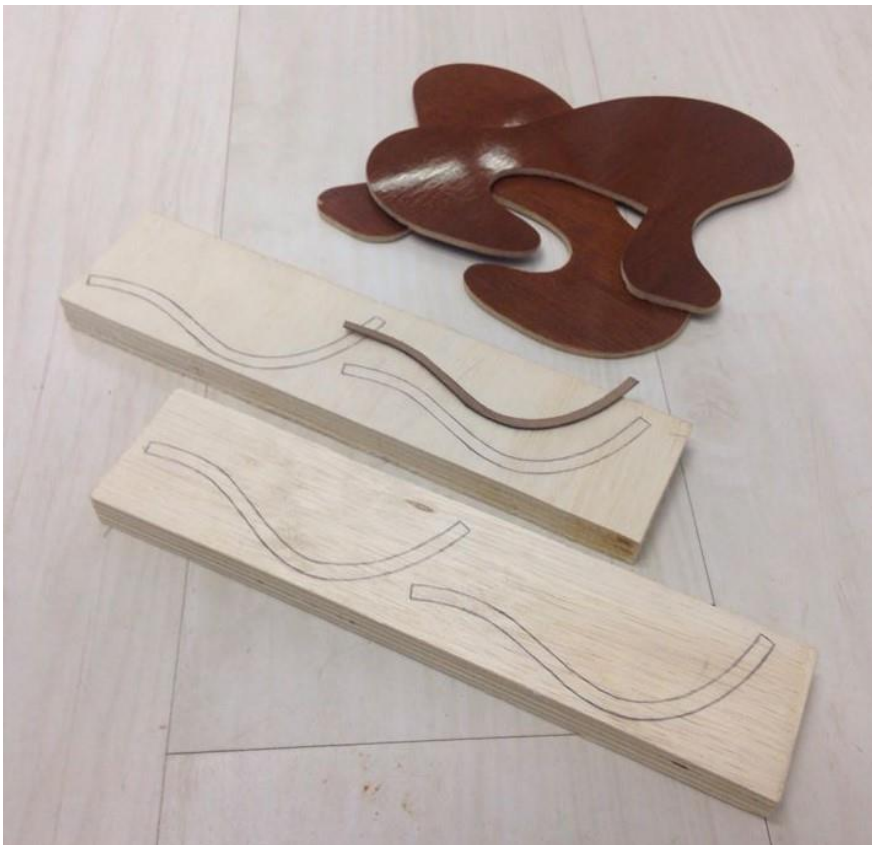
Fotos do molde da base desenhado e da lateral já cortada
