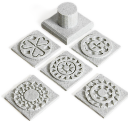
Imagem 23: Carimbos impressos. Dados: Impressora Angra 3D. Tempo de impressão: 13h (5 bases, e 1 suporte para estampar). Material utilizado: Filamento ABS
