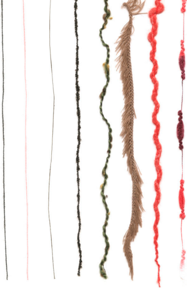
Imagem 10: É nesta etapa que ocorre a escolha de fios para a composição do tricô. Ao passo que cada um proporciona diferentes sensações à malha. Da esquerda à direita: Lã, Linha, Lurex, Mousse, Botonê, Angorá, Patagônia e Bally.
