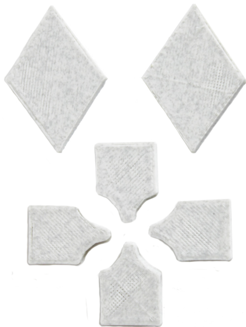
Imagem 24: Peças impressas. Dados: Impressora Angra 3D. Tempo de impressão: 8h (24 peças). Material utilizado: Filamento ABS.
