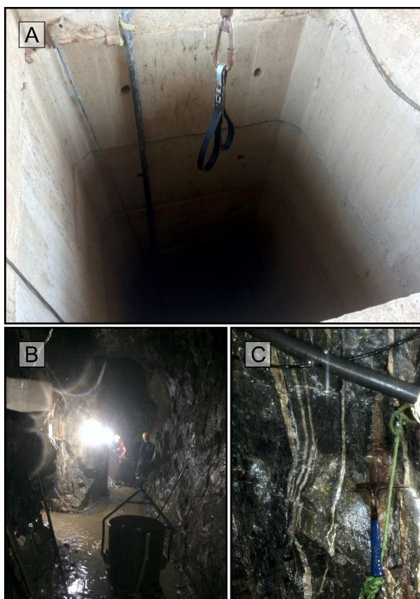
Figura 6.1 - (A) Vista da entrada do shaft do garimpo do Aguinaldo; (B) Entrada da galeria, ao final do shaft; (C) Veios de quartzo estéreis e tardios que truncam o sistema principal de veios.
