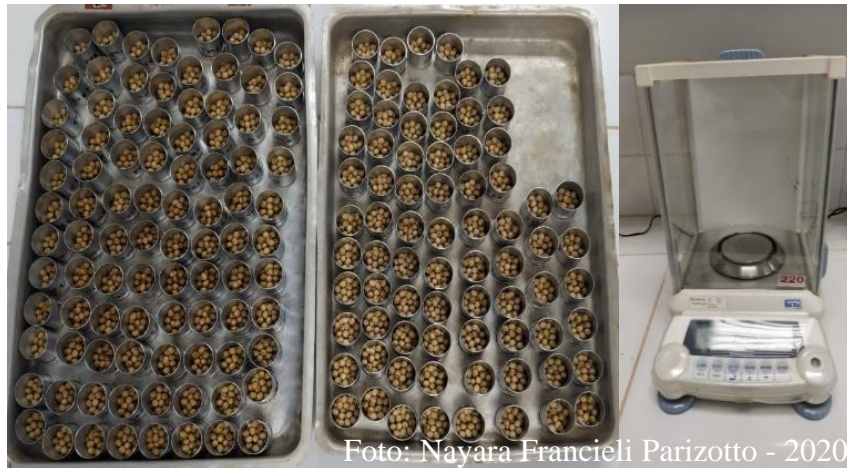
Figura 16 - Instalação do teste de Teor de Água para as sementes de soja e milho
