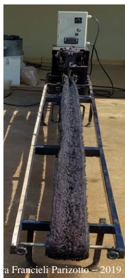
Figura 8 - Simulador de bancada para sistema de mecanismo dosador horizontal, neste sistema o dosador e o conjunto de disco e anel são acoplados no mecanismo, e a distribuição das sementes são realizadas através da individualização nos orifícios do disco
