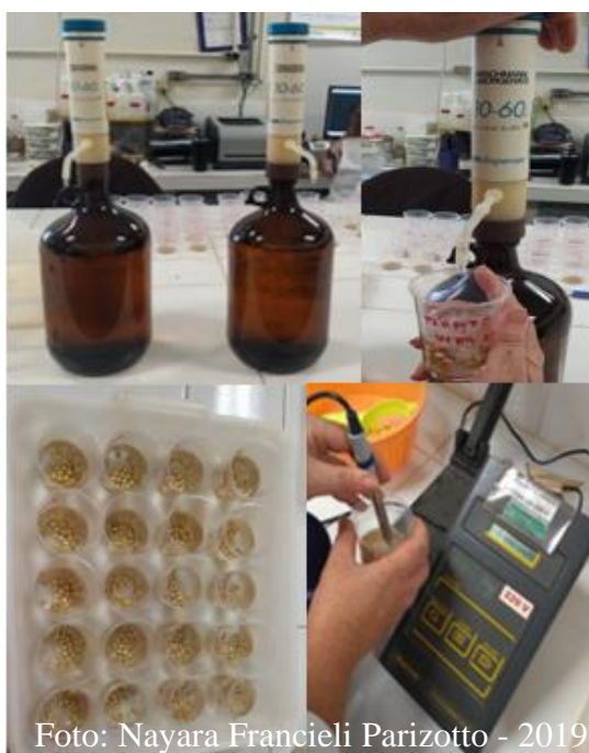
Figura 22 - Instalação e leitura do teste de condutividade elétrica em sementes de milho e soja
