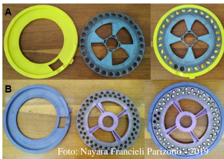
Figura 12 - Conjunto de discos e anéis utilizados para as sementes de milho (A) e soja (B) no dosador Titanium
