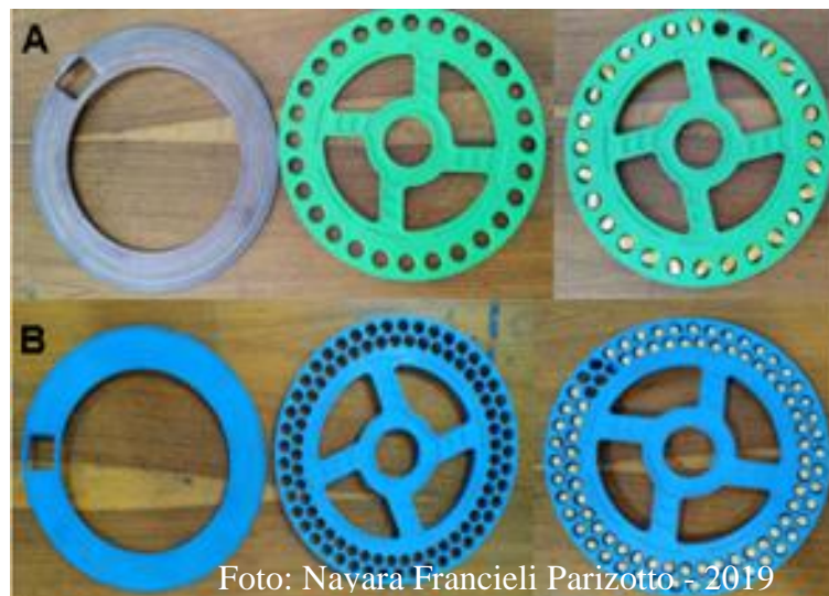
Figura 14 - Discos e anéis utilizados para as sementes de milho (A) e soja (B) no dosador Plantsystem
