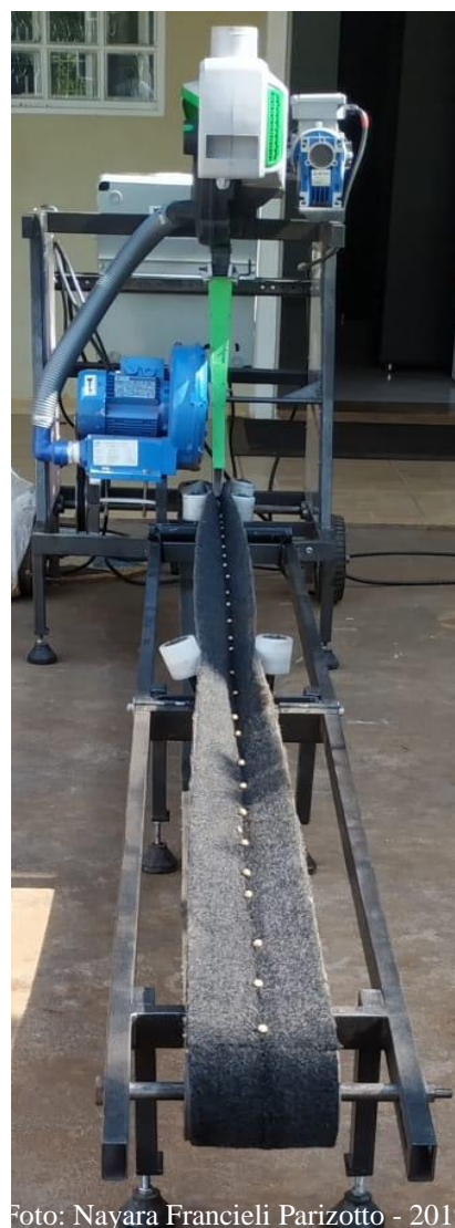
Figura 6– Simulador de bancada para o sistema de mecanismo dosador pneumático– Selenium, as sementes são individualizadas no disco dosador através da pressão negativa do vácuo gerado pela turbina
