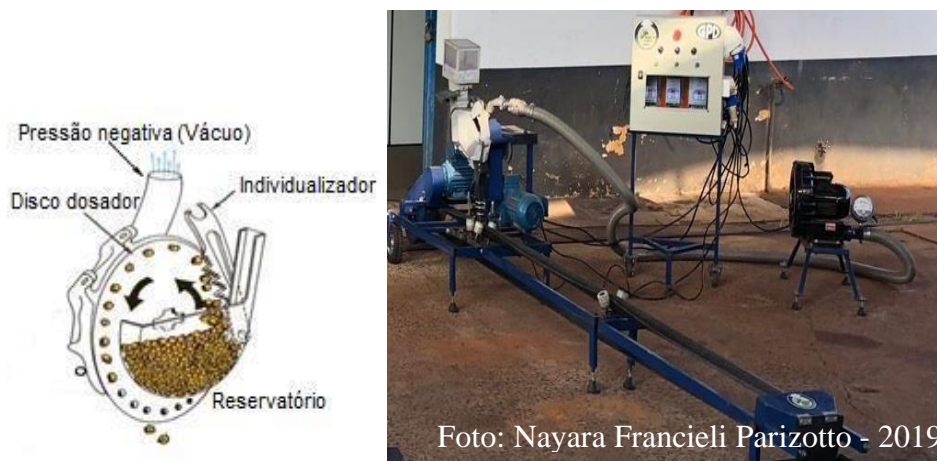
Figura 4 - Simulador de bancada de uma semeadora com sistema de mecanismo dosador pneumático Jumil®, as sementes são individualizadas no disco dosador através da pressão negativa do vácuo gerado pela turbina
