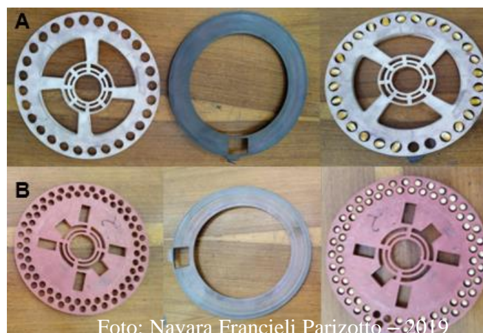
Figura 10 - Discos e anéis utilizados para as sementes de milho (A) e soja (B) no dosador Pipoqueira
