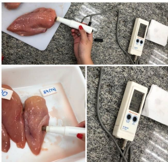
Figura 2. Determinação do pH da carne com o uso do eletrodo de inserção (Hanna, HI 99163).
