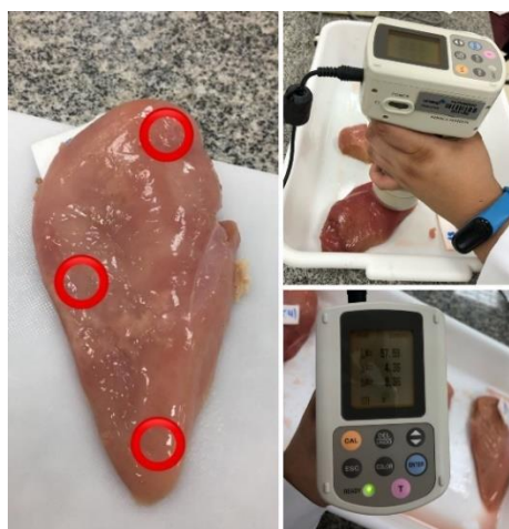
Figura 8. Leituras de reflectância de luz para determinação da cor da carne com o Colorímetro Konica Minolta (CR-400).
