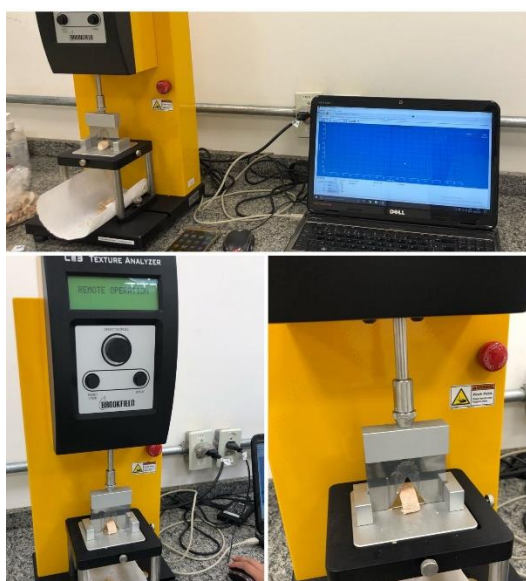
Figura 7. Procedimento para análise de determinação da força de cisalhamento.
