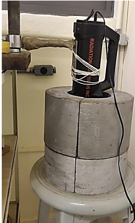
Figura 39 - Arranjo experimental para as leituras das amostras pulverizadas com o BGO inserido em blindagem de Pb.
