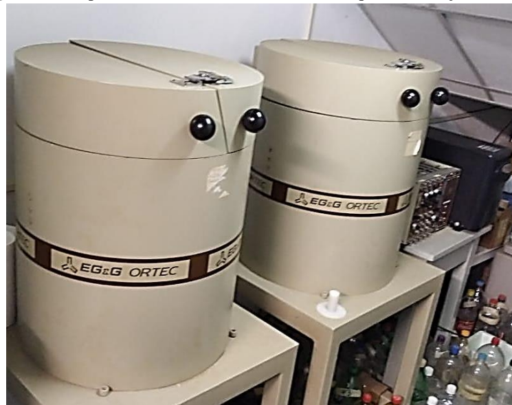
Figura 26 - Espectrômetros de bancada Torre (à esquerda) e Poço (à direita).
