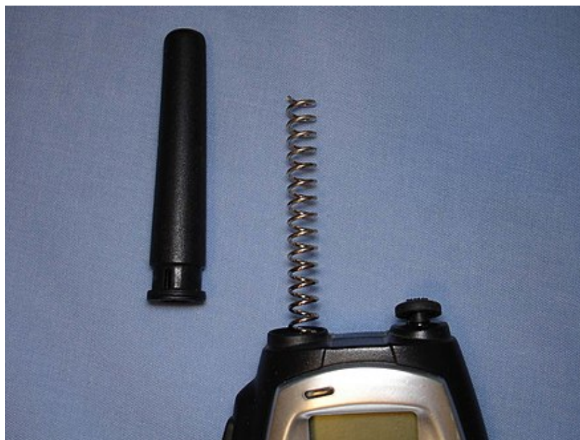
Figura 1 – Antena helicoidal utilizada em um rádio portátil.
