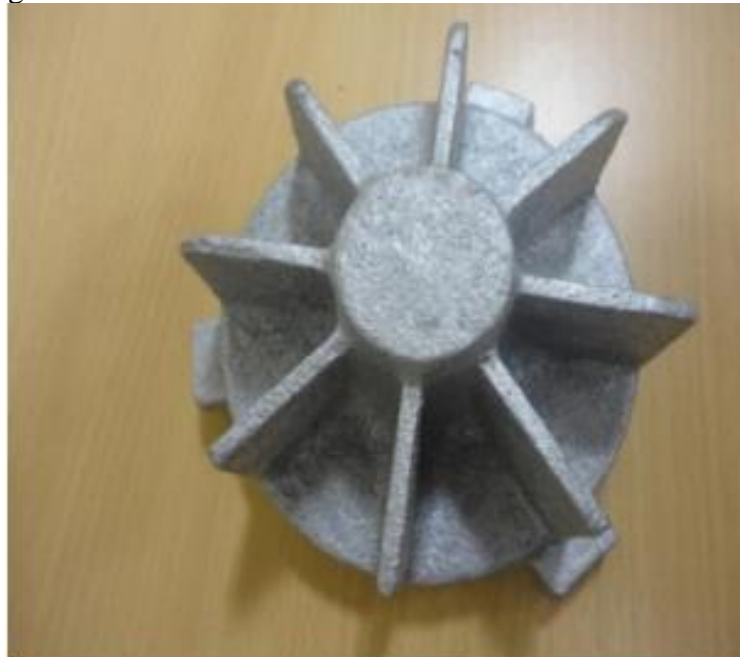
Figura 10 – Item feito através de um modelo de madeira
