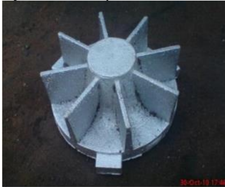
Figura 9 – Produto feito a partir do modelo de ABS
