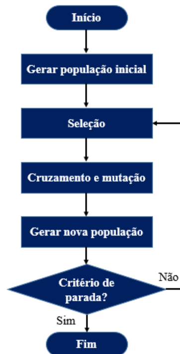
Figura 15 – Fluxograma de algoritmo genético
