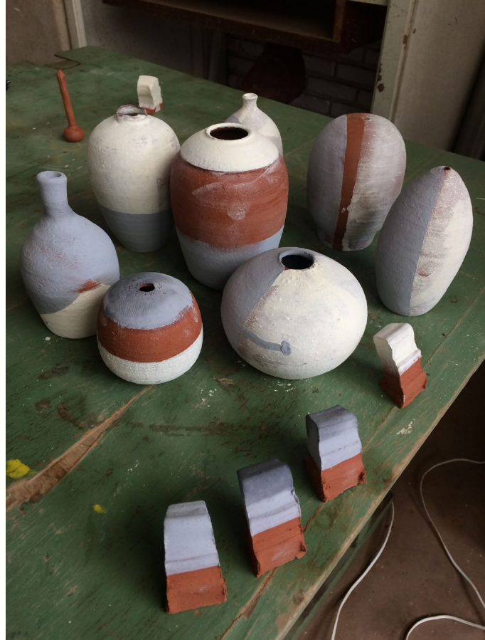
Figura 10: peças esmaltadas nas cores amarelo e azul, prontas para queima final.
