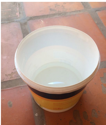
Figura 3: Se deve adicionar o pó do vidrado na água, caso contrário quando se adicionar água ao pó pode ser que se criem pelotas secas do pó e dificulte a penetração da água.
