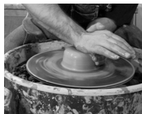
Figura 3: Após levantar a argila o segundo passo é “descer” ela, se estiver centralizada seguir para o próximo passo, caso contrário, repetir a primeira etapa.
