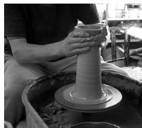
Figura 6: Objetivo é criar um cilindro, forma base que dará origem a qualquer outro formato de vaso. Fonte: https://i.ytimg.com/vi/b-o1hTijGpk/maxresdefault.jpg
