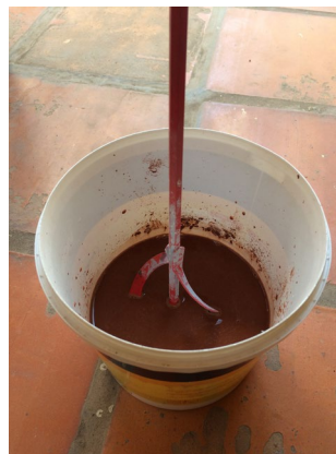
Figura 3: Se deve adicionar o pó do vidrado na água, caso contrário quando se adicionar água ao pó pode ser que se criem pelotas secas do pó e dificulte a penetração da água.
