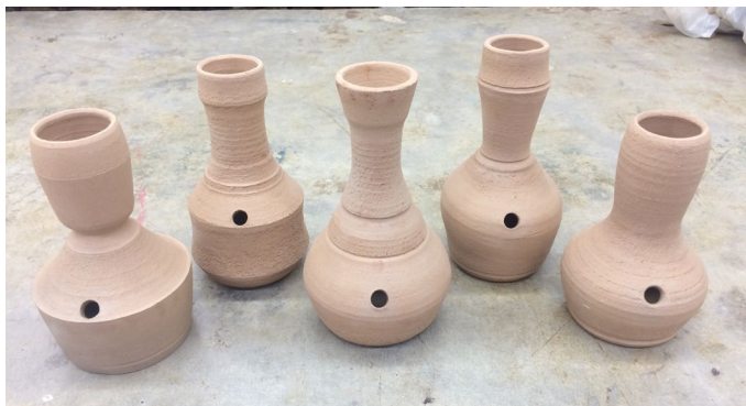
Figura 1: Peças finais após a primeira queima. Prontas para serem esmaltadas.
