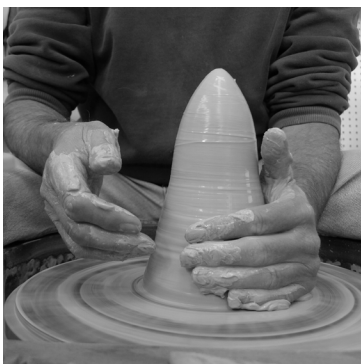
Figura 2: Primeira etapa para centralizar a argila no torno; levantar. Fonte: https://nehalembaypottery.files.wordpress.com/2012/05/p1080643.jpg
