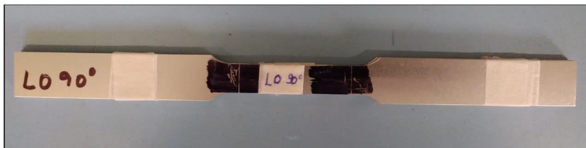
Figura 20: corpo de prova com comprimento útil de 50 mm marcado.
