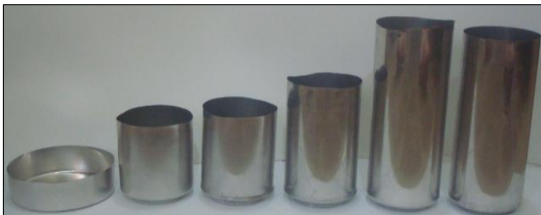
Figura 14 - etapas da conformação da lata por estampagem.
