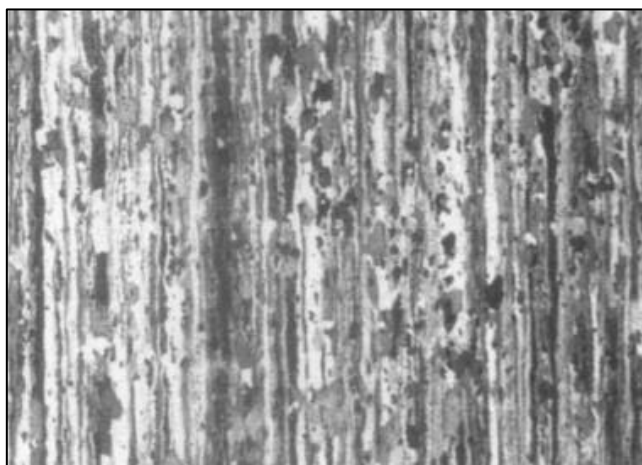
Figura 8 - microestrutura característica do alumínio laminado.
