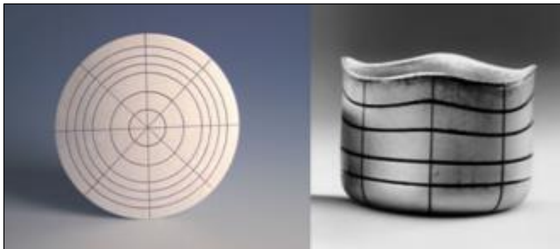
Figura 7 - orelhamento causado pela estampagem de uma chapa anisotrópica.
