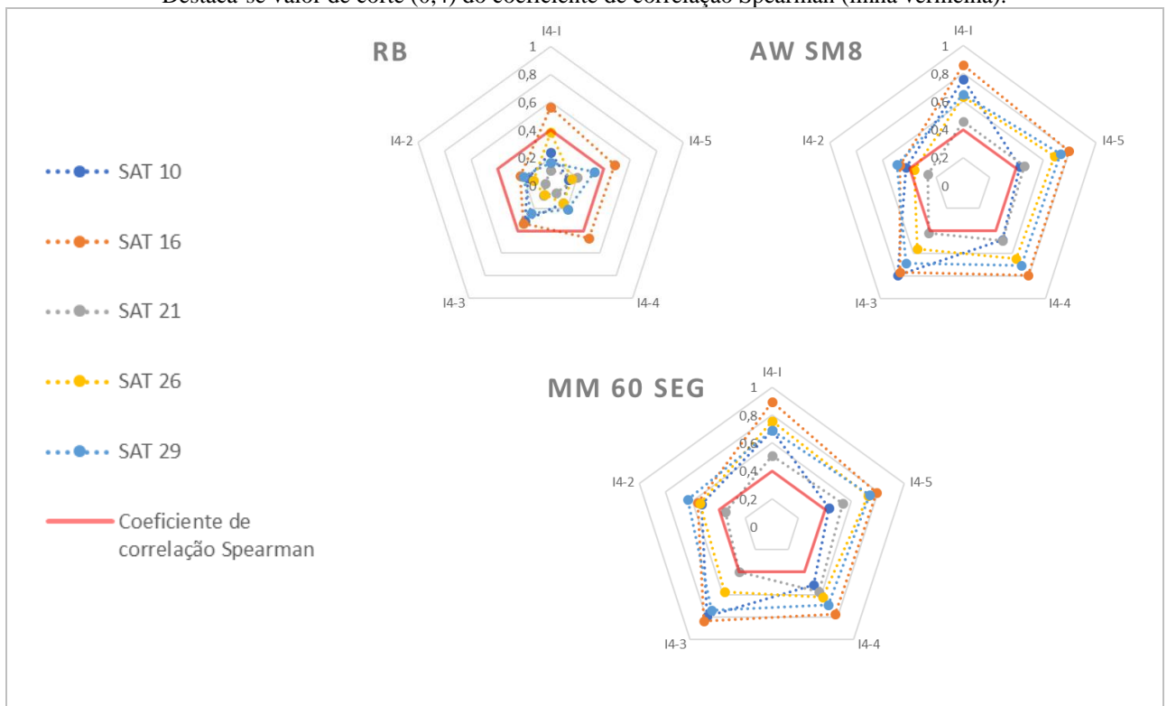
Figura 33 – Comparação entre os coeficientes de correlação de Spearman para cada um dos métodos (RB, AW e MM) para todos os satélites (sat 10, 16, 21, 26, e 29) em cada um dos cenários (I4-I, I4-5, I4-4, I4-3 e I4-2). Destaca-se valor de corte (0,4) do coeficiente de correlação Spearman (linha vermelha).
