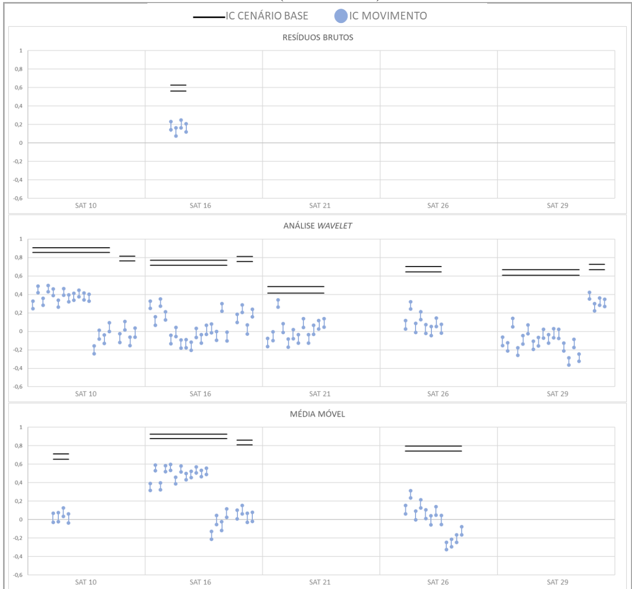
Figura 34 – Verificação por meio do IC para todos os satélites (sat 10, 16, 21, 26, e 29) nos métodos de RB, AW e MM para as inclinações de 5°, 4°, 3°, 2° e 1°. Destacando os deslocamentos que pertencem ao IC base (círculo vermelho).
