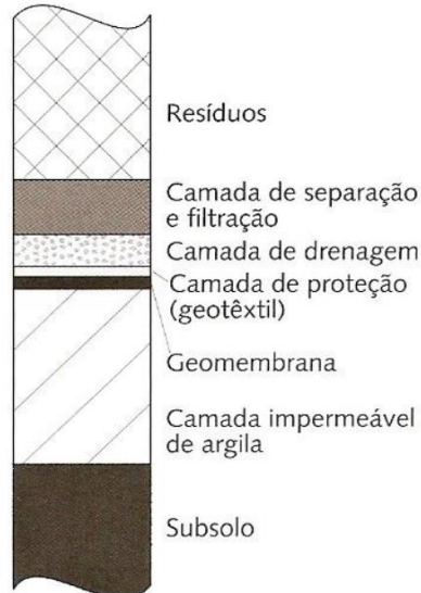
Figura 11 - Configuração de uma camada de proteção de fundo de aterro sanitário
