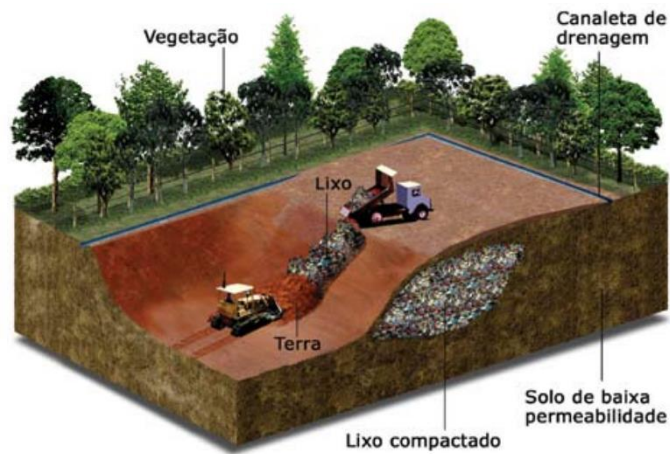
Figura 15 - Disposição final de resíduos em aterro com o método construtivo de rampa
