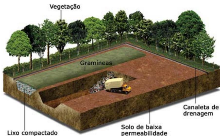
Figura 17 - Disposição final de resíduos em aterro com o método construtivo de valas
