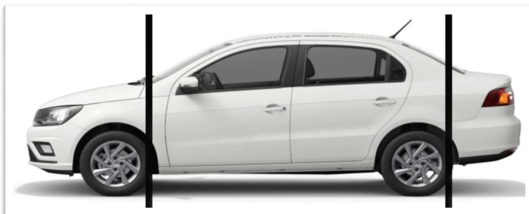
Figura 23 – Automóvel de 3 volumes, com compartimentos bem destacados.
