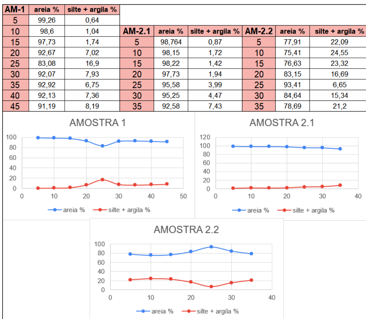
Figura 21 - Gráficos de correlação entre profundidade (eixo x, em cm) e os percentuais de areia e silte+argila dos sedimentos de fundo (eixo y, em %).
