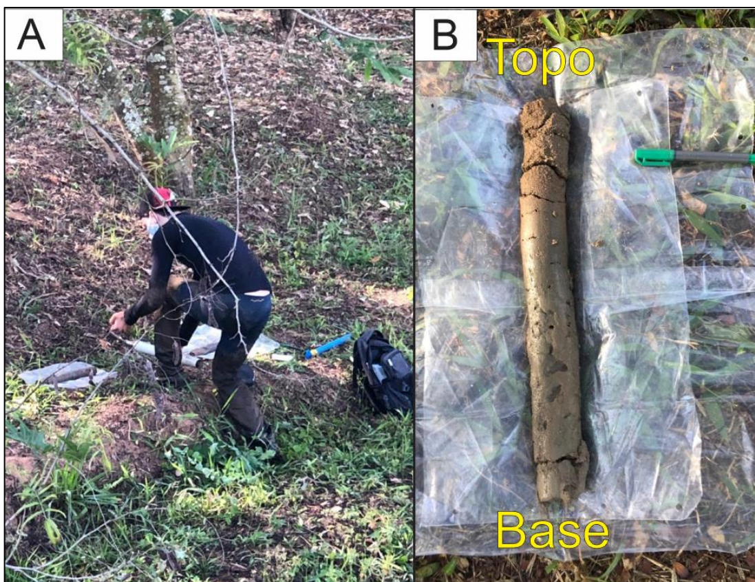
Figura 15 – Coleta da amostra no ponto 1 Em A preparação do armazenamento da amostra coletada no ponto 1. Em B, testemunho do ponto 1 com seu topo e base identificados.
