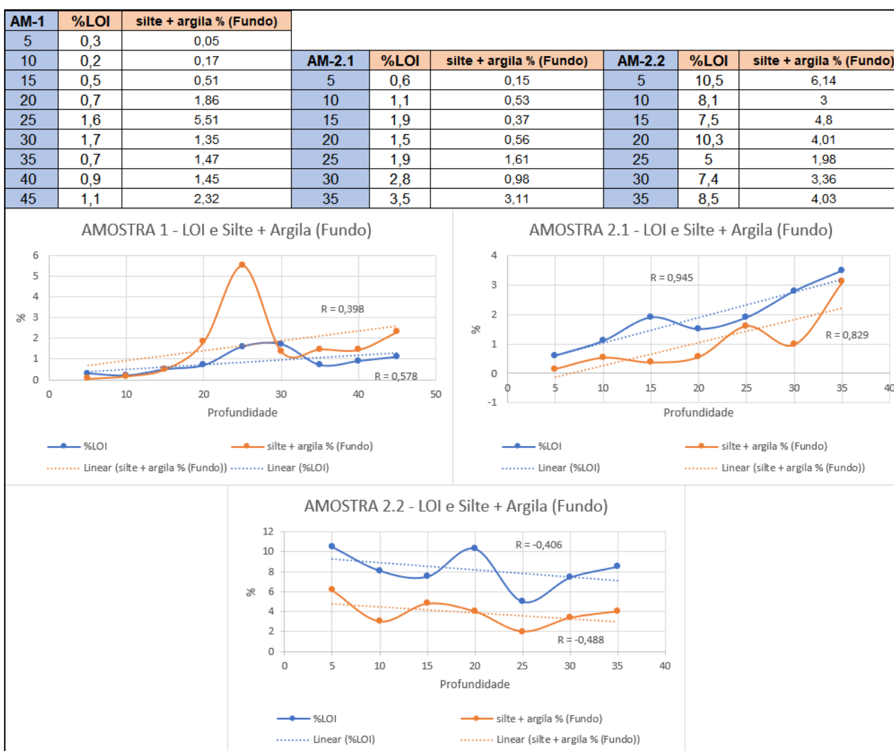
Figura 22 - Gráficos de correlação entre profundidade (em cm) e percentuais de LOI e os percentuais dos sedimentos de fundo. Também estão identificados os coeficientes de correlação ( r ).
