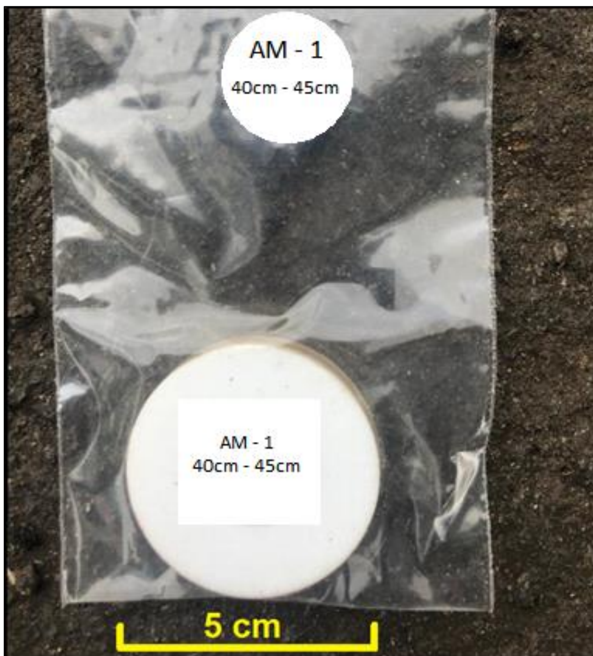
Figura 19 – Exemplo de um dos discos confeccionados para a análise por fluorescência de Raios X com 5 centímetros de diâmetro.
