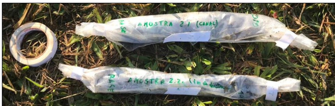
Figura 18 – Testemunhos dos pontos 2.1 e 2.2 armazenados e lacrados em sacos plásticos, tendo seu topo e sua base devidamente diferenciados.
