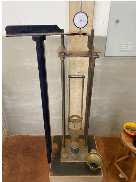
Figura 12 - Equipamento para compactação em miniatura
