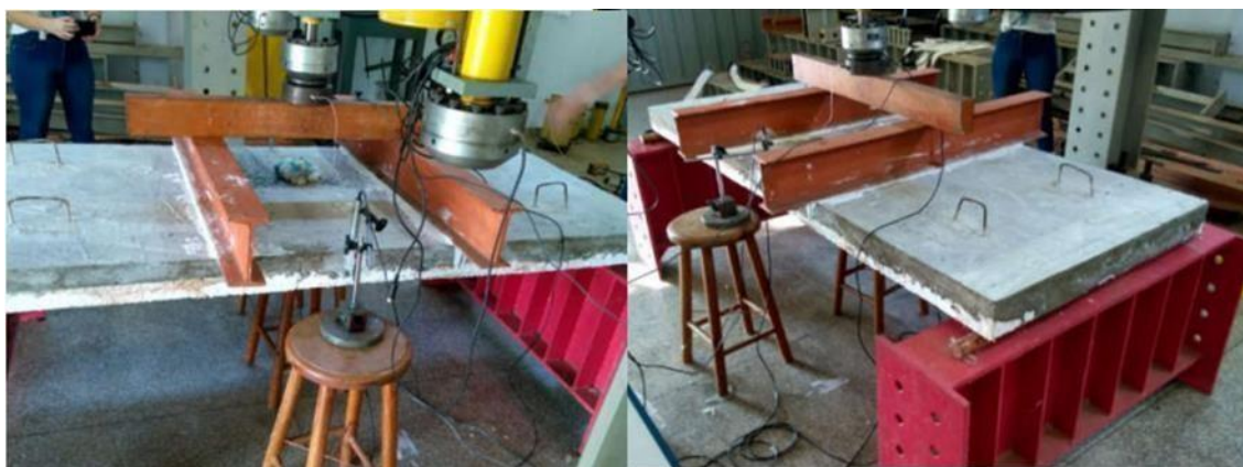
Figura 56 – Exemplo de laje posicionada para o ensaio de flexão a 4 pontos
