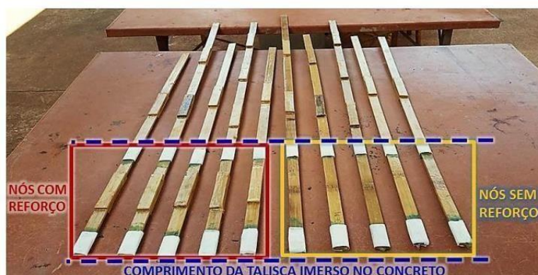
Figura 26 – Taliscas prontas para o ensaio de arrancamento
