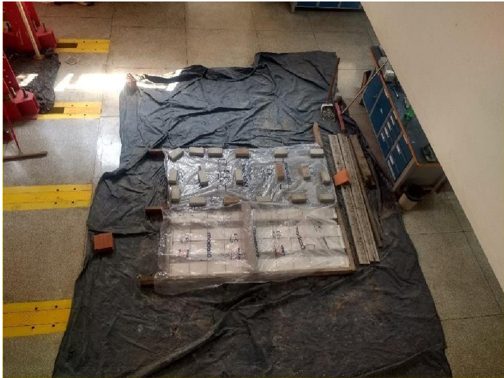
Figura 54 – Cura da Laje
