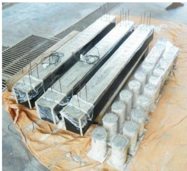
Figura 32 – Vigas concretadas com seus respectivos corpos de prova
