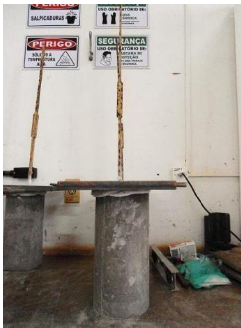
Figura 28 – Corpo de prova de arrancamento capeado com gesso
