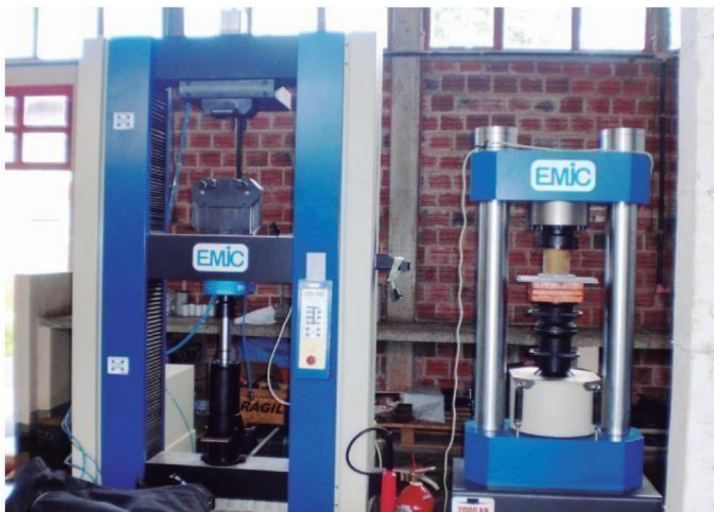
Figura 8 – Ensaio de compressão de colmo de bambu em prensa hidráulica
