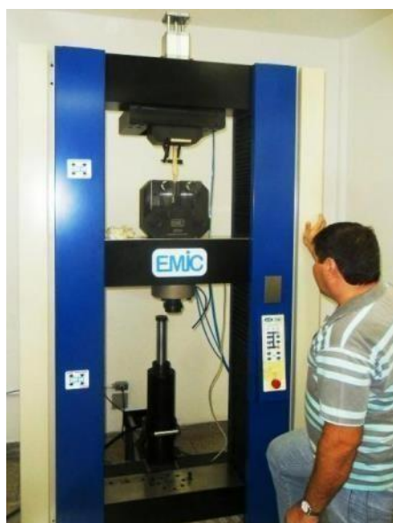
Figura 22 – Ensaio de tração de talisca
