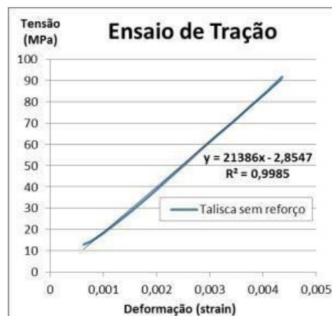
Figura 24 – Ensaio de tração de taliscas sem reforço nos nós
