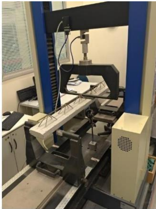
Figura 38 – Posicionamento da vigota para o começo do ensaio
