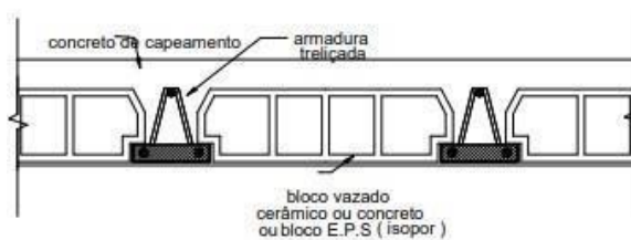
vigota com armadura treliçada
