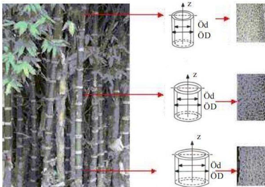
Figura 11 – Representação da variação radial dos colmos de bambu da espécie Guadua Angustifolia
