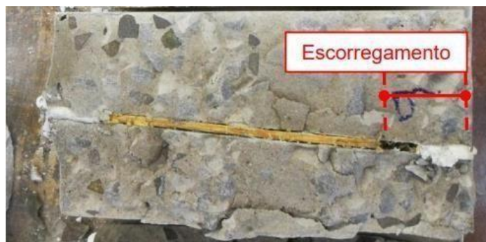
Figura 29 – Exemplo de escorregamento durante ensaio de arrancamento
