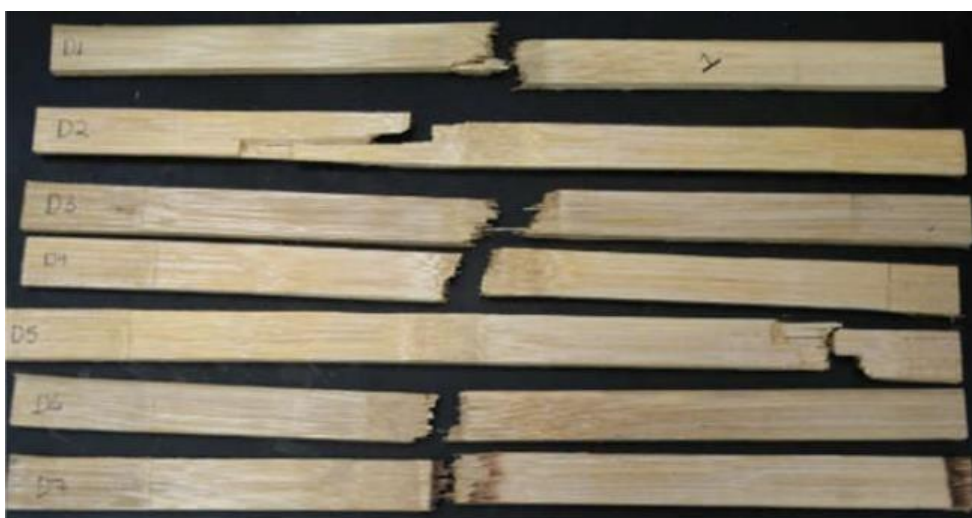
Figura 58 – Exemplo de rompimento de taliscas
