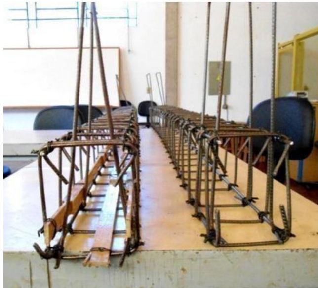
Figura 31 – Armadura com bambu reforçado (à esquerda), e armadura referência (à direita)
