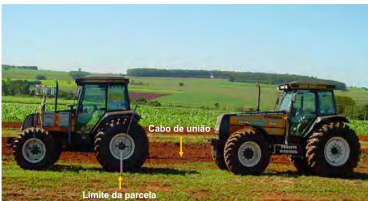
Figura 10. Avaliação do ensaio de desempenho do trator de teste tracionando trator de frenagem.
