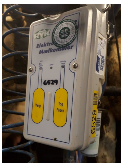
Figura 5 - Aparelho utilizado para o controle da produção de leite
