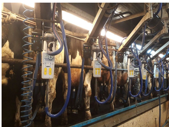
Figura 5 - Aparelho utilizado para o controle da produção de leite
