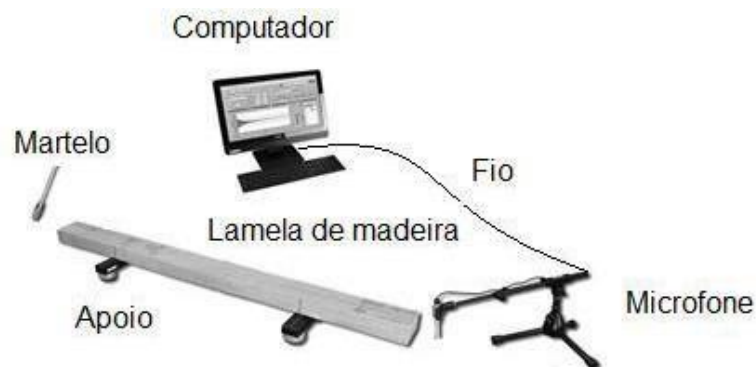
Figura 12 - Método de ensaio de excitação por impulso – Equipamento Sonelastic
