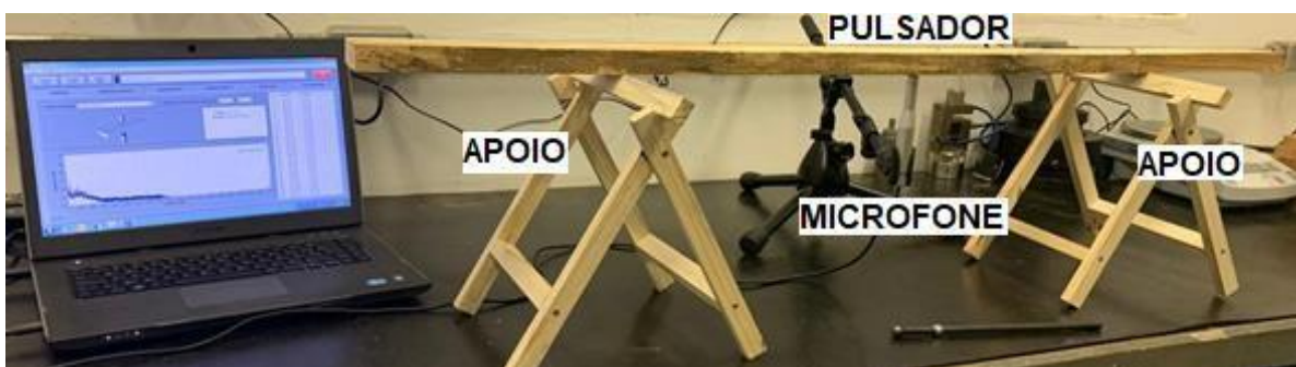
Figura 28 - Ensaio de excitação por impulso flexional ( E_{dF} ) biapoiado
