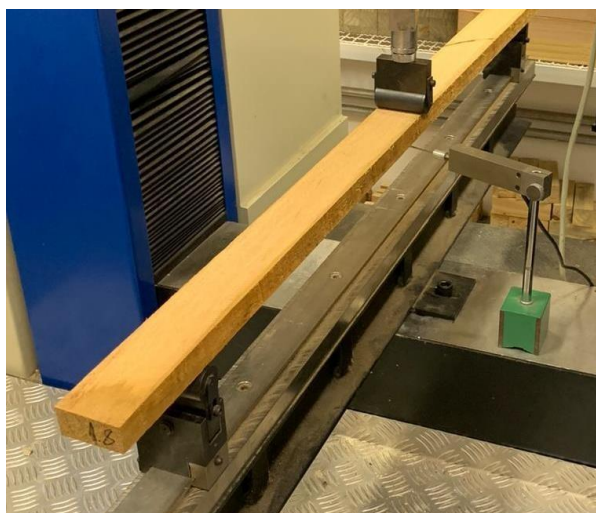
Figura 31 – Ensaio de Flexão estática de três pontos com base no Anexo B da ABNT NBR 7190:1997 para determinação de E_M
