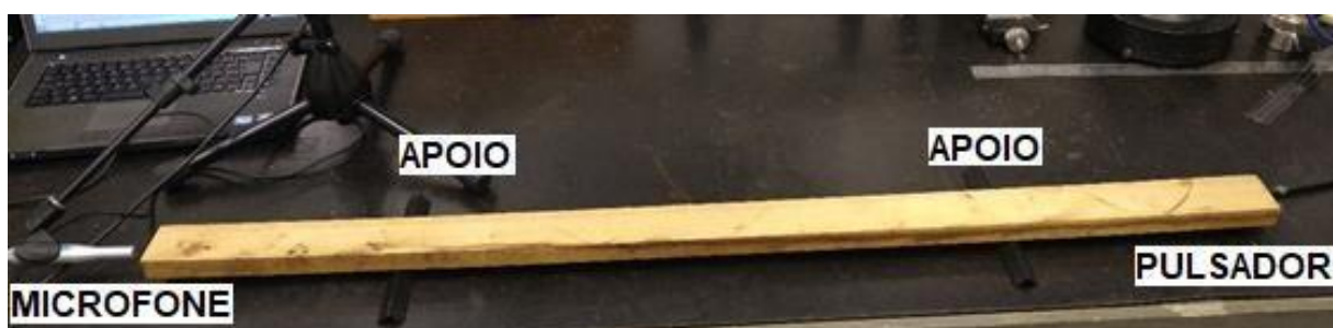
Figura 26 - Ensaio de excitação por impulso longitudinal ( E_{dL} ) biapoiado
