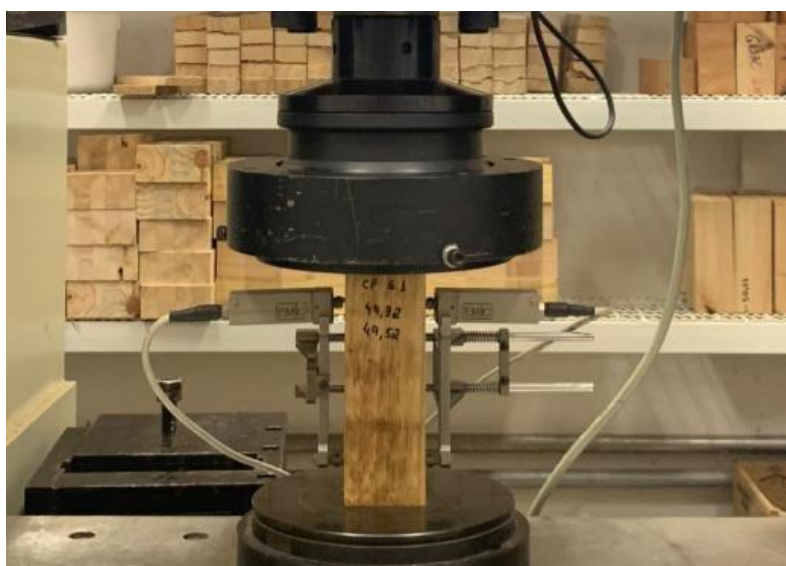
Figura 25 - Ensaio destrutivo de compressão paralela as fibras.
