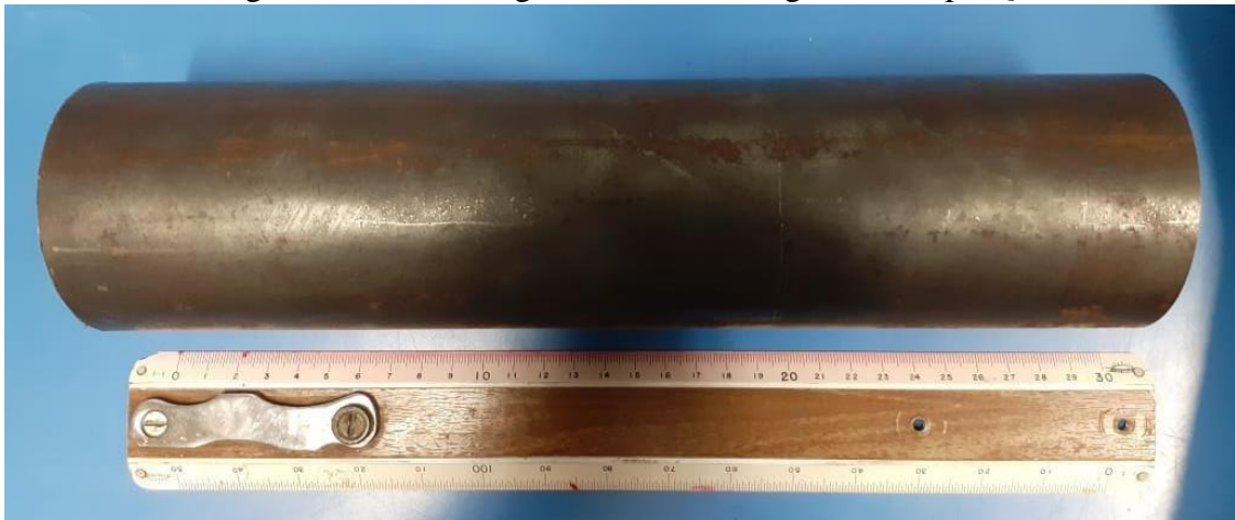
Figura 16 – Tubo longitudinal API 5CT grau N80 tipo Q.
