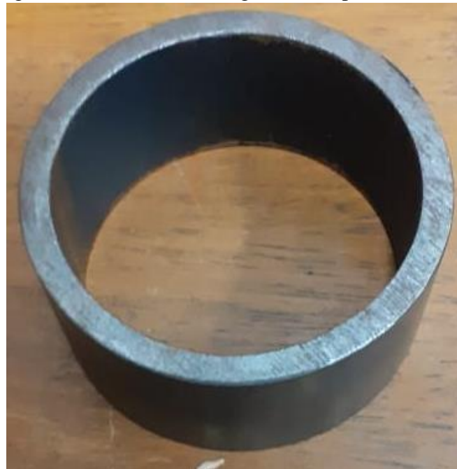
Figura 15 - Tubo API 5CT grau N80 tipo Q em corte.
