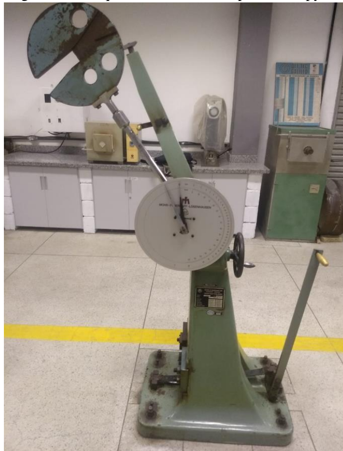
Figura 25 - Máquina de ensaio de impacto Charpy-V.
