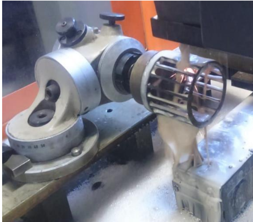
Figura 17 – Corte das amostras por eletroerosão a fio.
