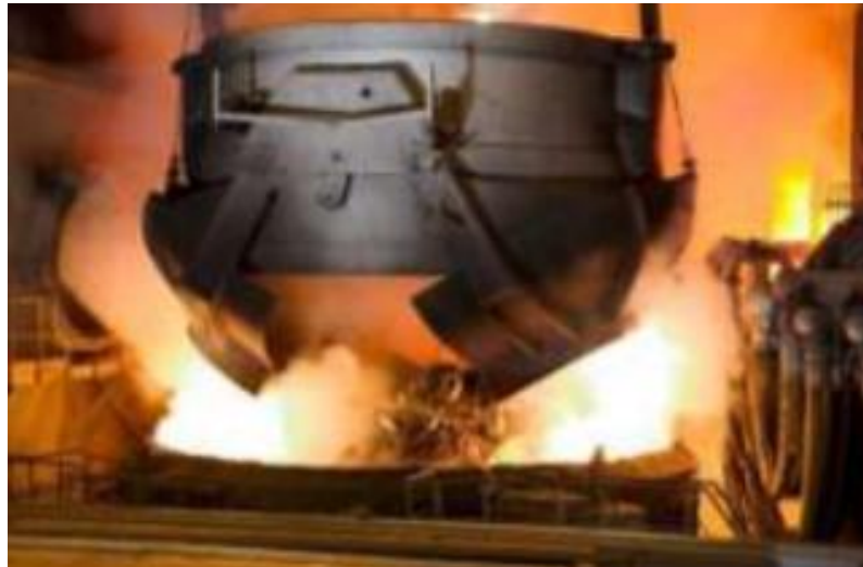
Figura 3. Carregamento de sucata.
