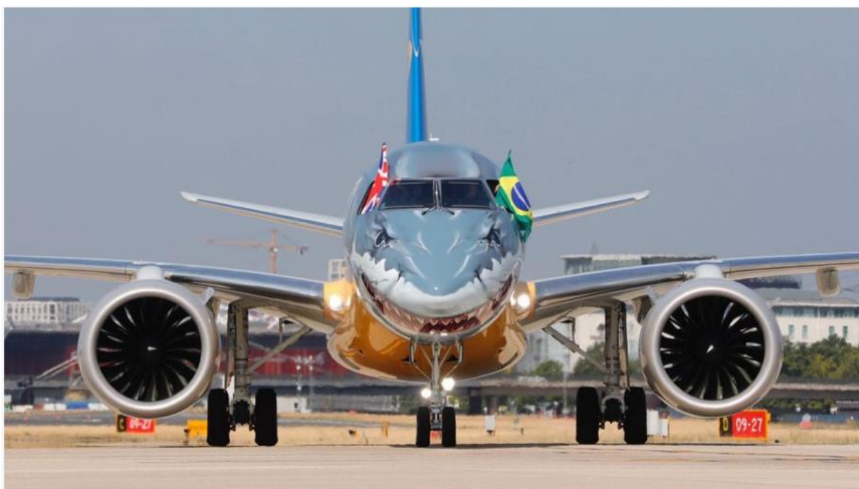
Figura 5 – Perna de força principal com a instalação de duas rodas.
