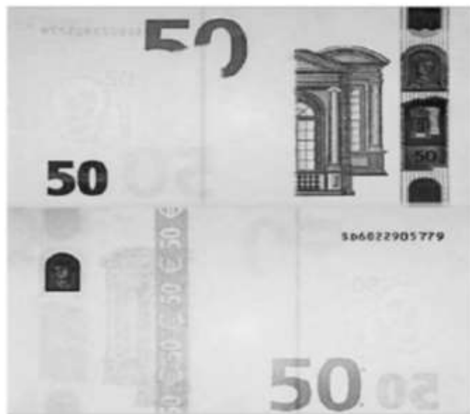
Figura 16. Nota de Euro exposta a radiação infravermelha.
