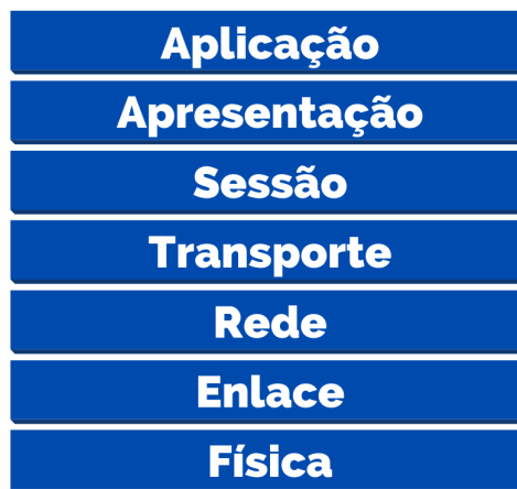
Figura 14 – Camadas do Modelo OSI
