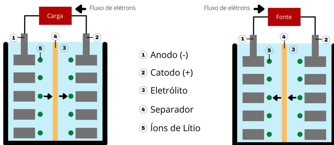
Figura 1 – Processo de carga e descarga em Célula Íon-Lítio
