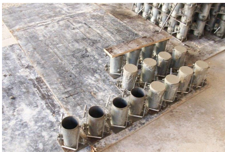
Figura 10 - Formas de graute cheias para modelagem dos corpos de prova
