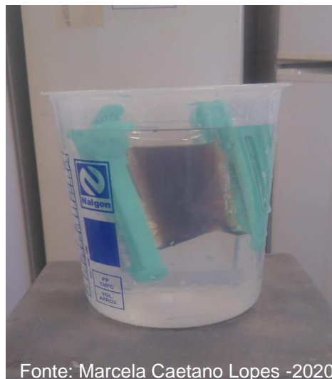
Figura 1 - Filtração do precipitado de ácido húmico através de membrana de diálise de massa molar de 1000D
