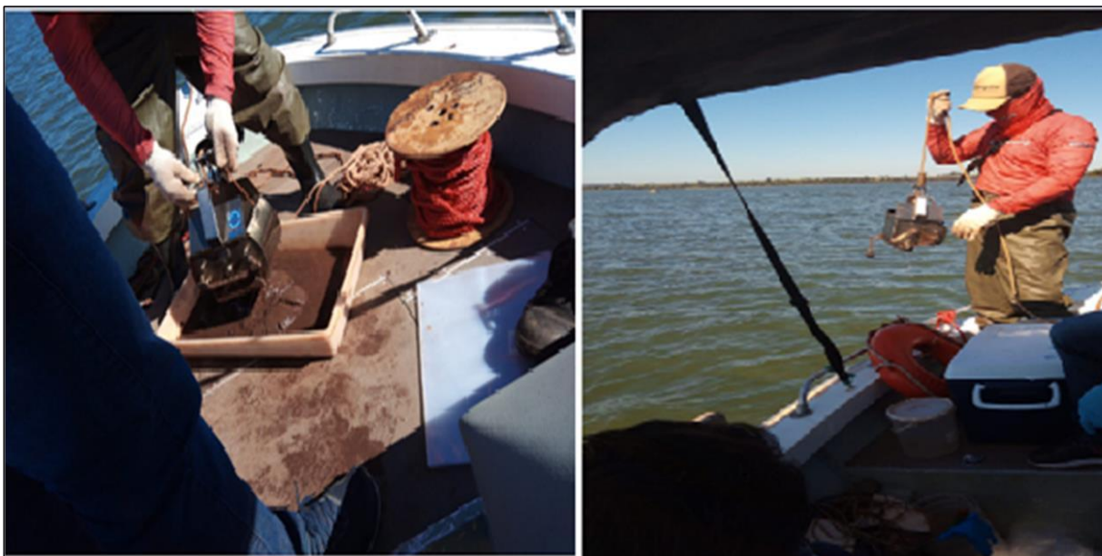
Figura 4. Coletas utilizando uma draga de modelo Ekman.
