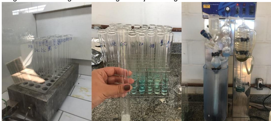
Figura 8: Bloco Digestor / Homogeneização da digestão / Destilador
