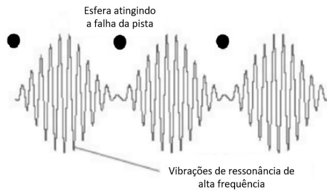
Figura 2.12 – Efeito ressonante e seu sinal de aceleração no espectro de tempo
