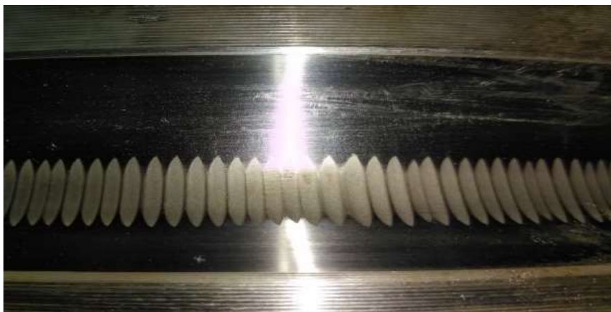
Figura 3.12 – Marcas estriadas na pista interna do rolamento
