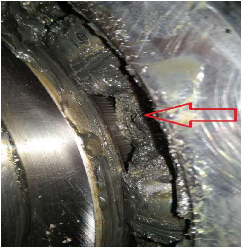
Figura 3.11 – Rolamento com marcas estriadas na pista interna
