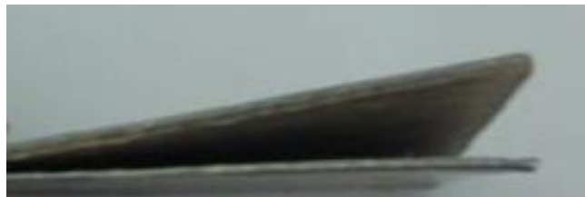
Figura 31 - Laminados com delaminação após algumas horas de repouso.
