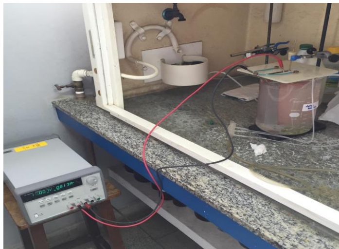
Figura 11 - Aparelhagem utilizada para anodização.
