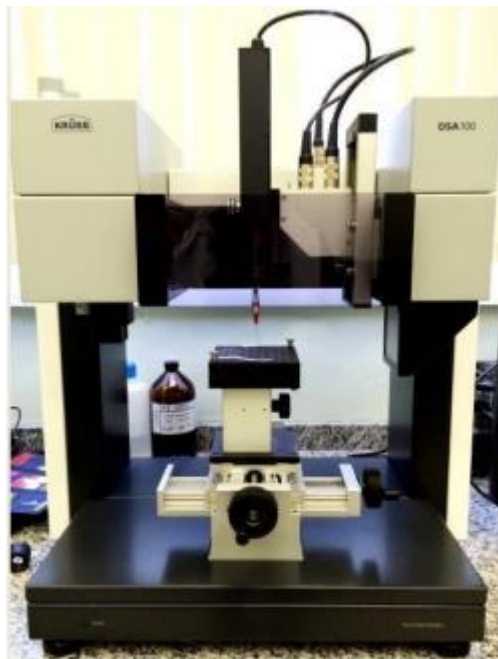
Figura 12 - Equipamento utilizado para o ensaio de ângulo de contato.
