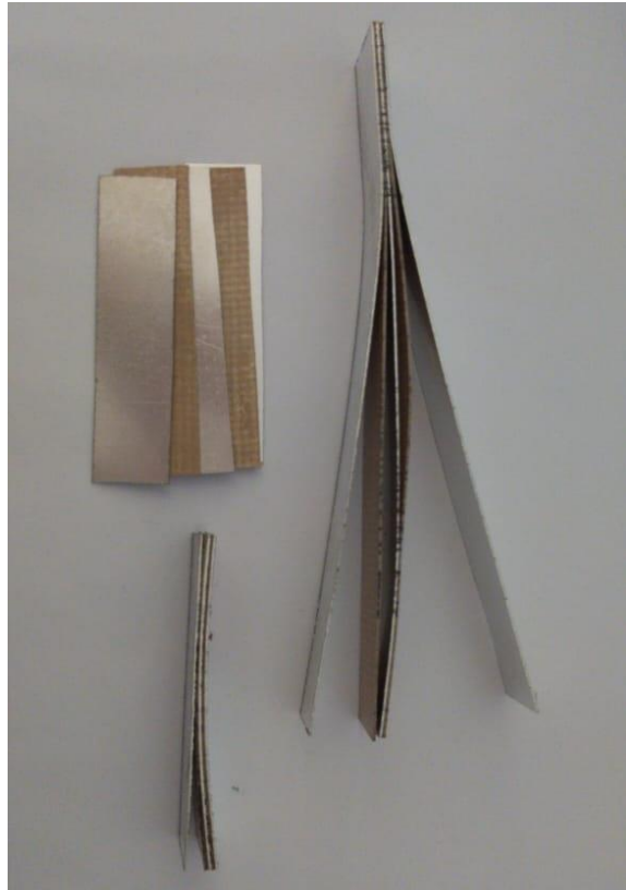
Figura 32 - Corpos de prova a partir de lâmina decapada que apresentaram abertura entre as camadas após o corte.
