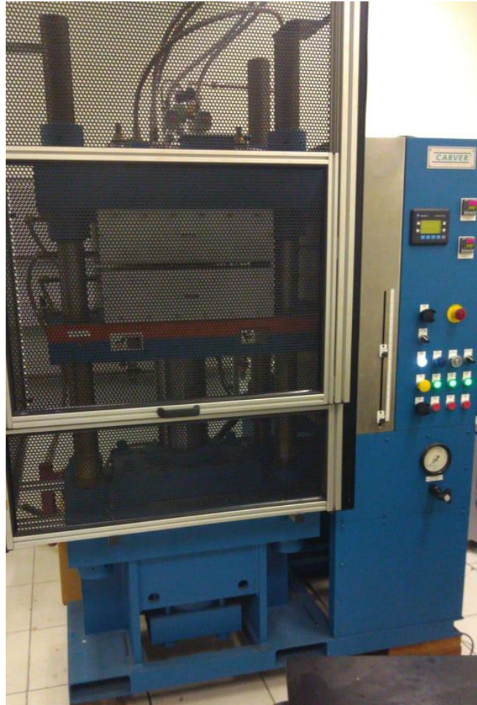
Figura 13 - Prensa utilizada para o processamento por compressão a quente.
