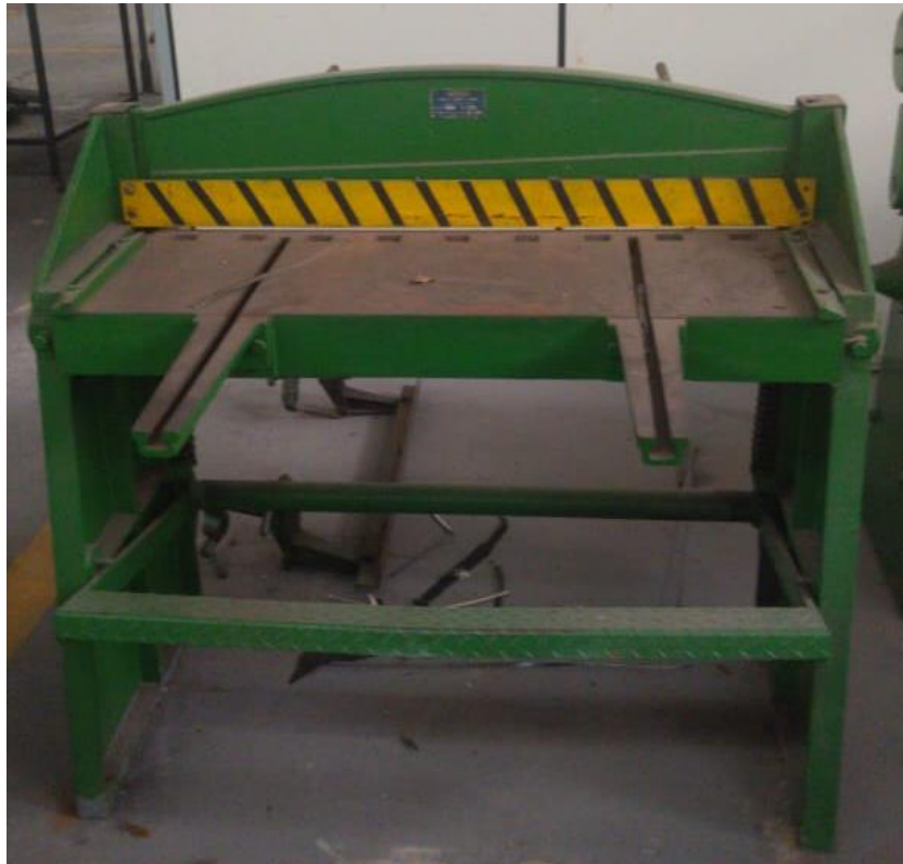
Figura 10 - Guilhotina utilizada para corte das placas de alumínio.
