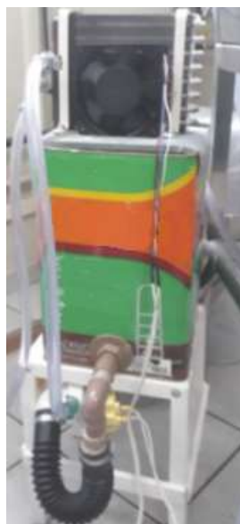
Figura 19 – Sistema de resfriamento dos selos.
