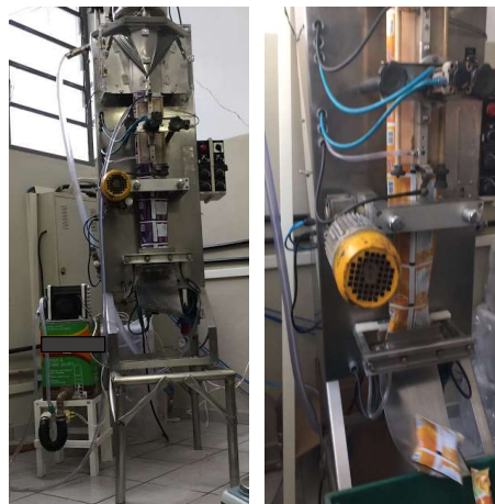
Figura 13 – Máquina de envase Prepac-Dermec 1000 do DPD/UNESP.
