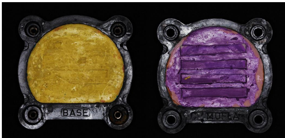
Figura 2. Molde incluído em mufla para confecção das amostras convencional e processada por micro-ondas.
