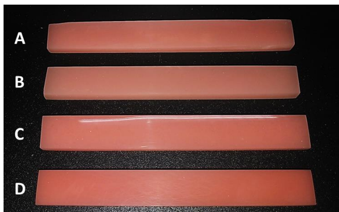
Figura 3. Amostras confeccionadas de acordo com as medidas estabelecidas: A – resina convencional; B – resina processada por micro-ondas; C – resina fresada; D – resina impressa 3D.
