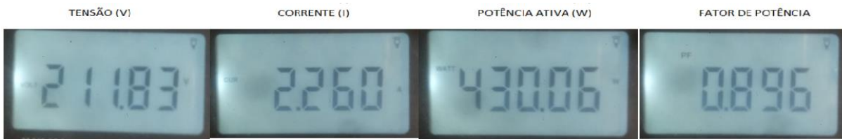
Figura 20 - Medições do GM 86 da carga indutiva com correção
