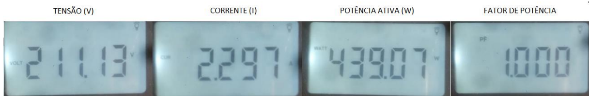
Figura 12 - Medições GM 86 para carga resistiva
