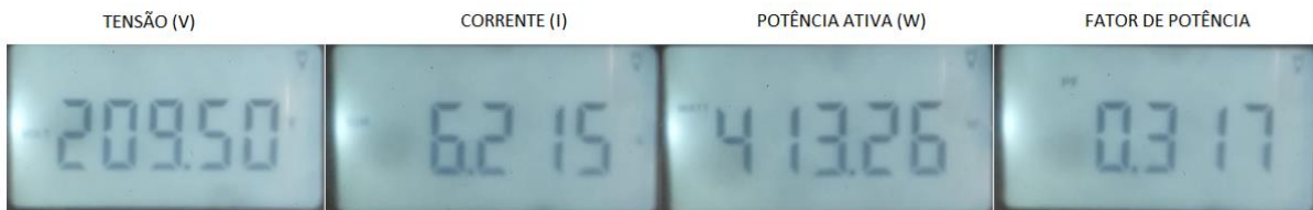
Figura 16 - Medições do GM 86 de carga indutiva sem correção.
