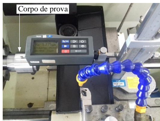
Figura 3.22 – Medição da rugosidade.
