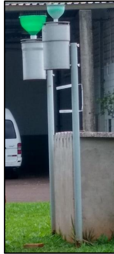
Figura 5.9 Modelo de pluviômetro PALMEX utilizado para coletar as amostras de precipitação.
