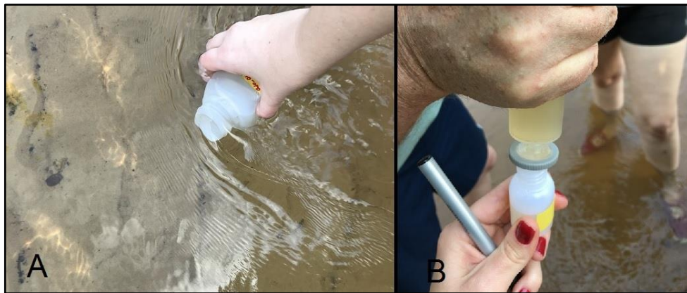
Figura 5.5 A. Amostragem para concentração de nitrato coletadas no canal. B. Amostragem para isótopos estáveis, filtradas no local.
