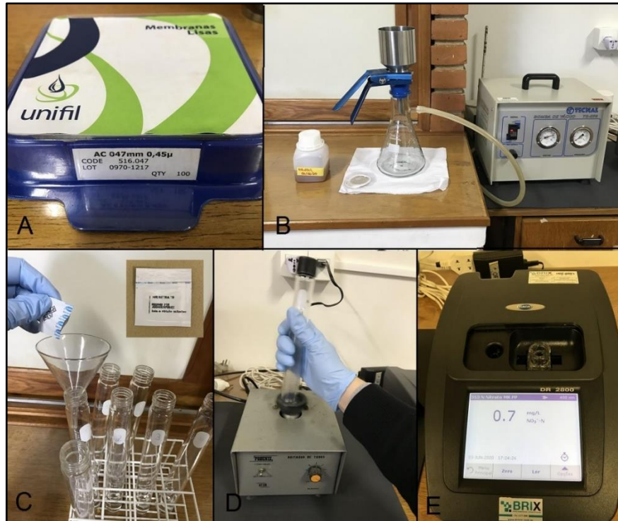
Figura 5.10 A. Membranas de acetato de celulose de 0,45 \mu\text{m} . B. Filtragem das amostras utilizando bomba a vácuo elétrica. C. Reagente para nitrato sendo colocado em cada amostra e no branco. D. Tubo de amostra com reagente sendo agitado no agitador de tubos. E. Espectrofotômetro após ter feito a leitura do nitrato na amostra.
