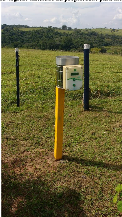
Figura 8 - Pluviógrafo instalado na propriedade para monitoramento.
