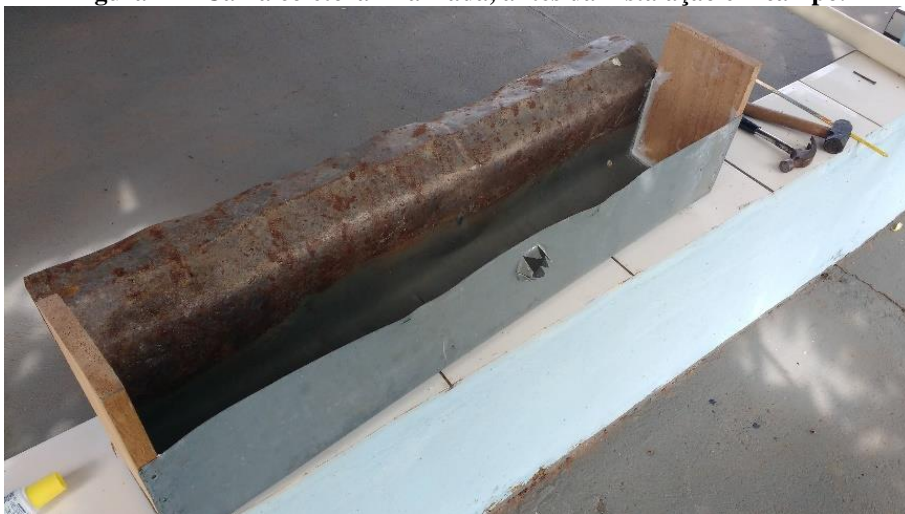
Figura 14 - Calha coletora finalizada, antes da instalação em campo.
