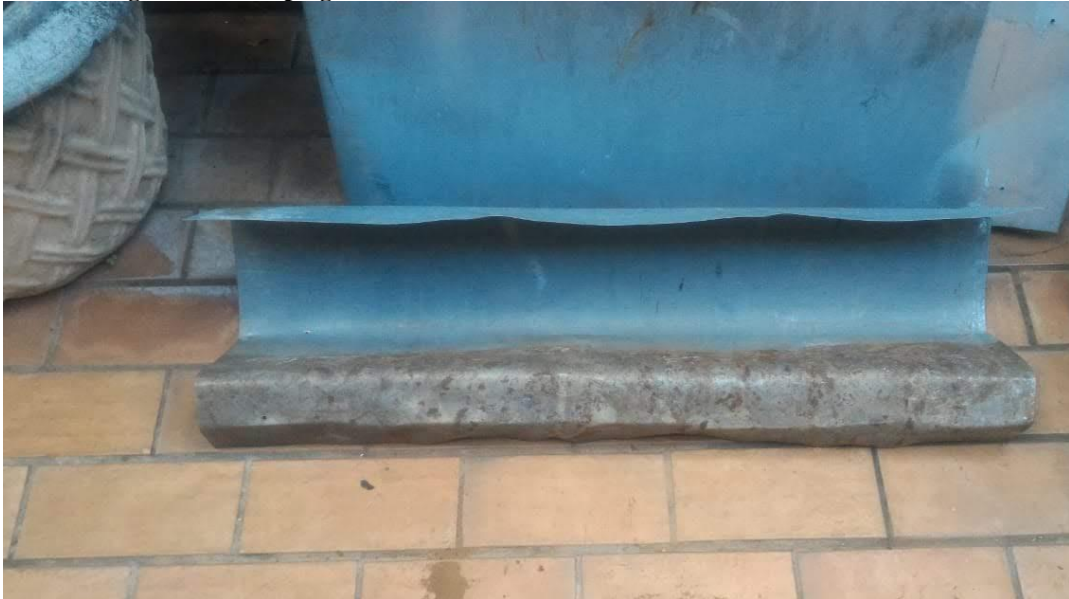
Figura 10 - Chapa galvanizada de forma a ser utilizada como calha coletora.
