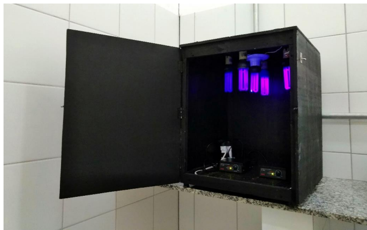
Figura 18 – Câmara escura construída para os tratamentos com ultravioleta
