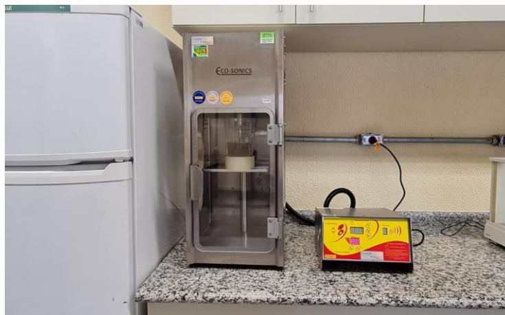
Figura 19 – Aparelho Eco-sonics modelo QR500, 20 kHz de frequência, utilizado para os tratamentos com ultrassom
