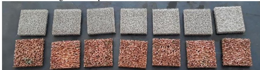
Figura 18. Superfícies cortadas na eletroerosão.
