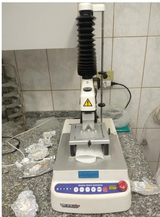
Figura 9 – Amostra de L. lumbrorum com 1cm 2 , grelhada e resfriada sendo cortada com sentido das fibras perpendicular à lâmina do dispositivo Warner-Bratzle Meat Shear.
