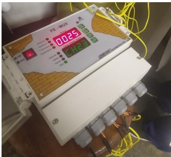
Figura 8 – Termopar, equipamento indicador de temperatura, registrando a temperatura interna das amostras de L. lumbrorum .
