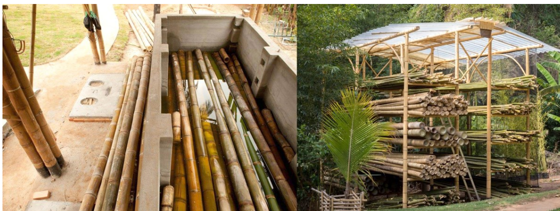
Figura 61 - Local de tratamento por imersão e secagem e estoque de colmos
