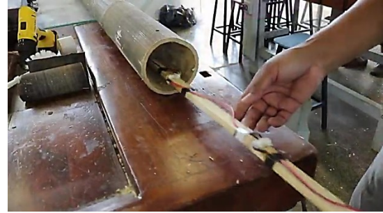
Figura 120 - Detalhe da fixação dos LEDs
