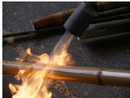
Figura 12 - Tratamento pela ação do fogo - maçarico
