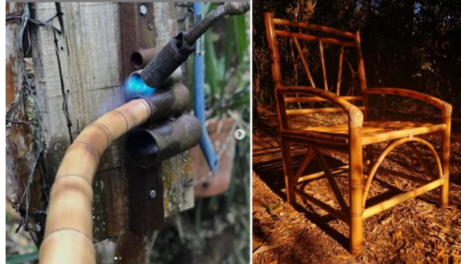
Figura 23 - Curvatura com aplicação de calor sem molde
