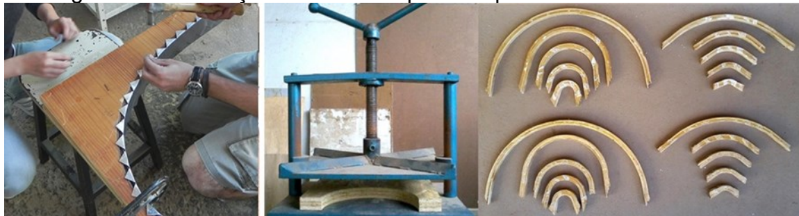
Figura 24 - Confeção de moldes aquecidos para curvatura de lâminas
