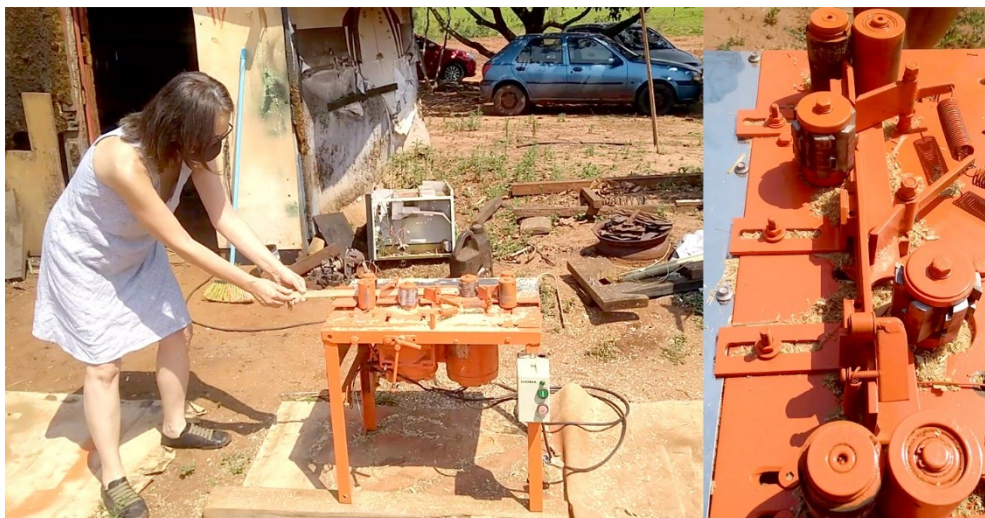
Figura 128 - Máquina fresadora para laminação de ripas de bambu
