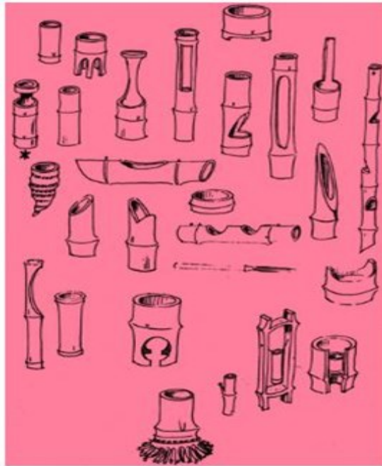
Figura 17 - Cortes diversos sobre a estrutura tubular de bambus
