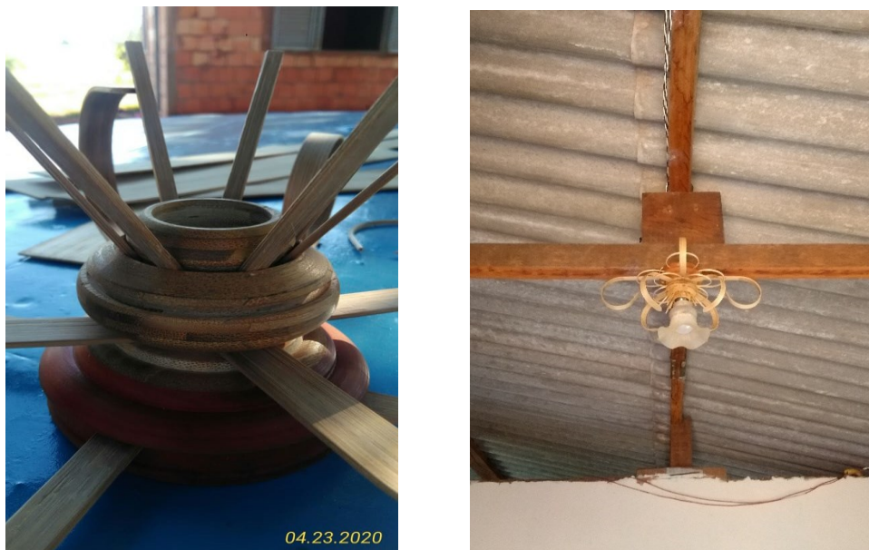
Figura 126 - Confeção de luminária com lâminas curvadas por calor
