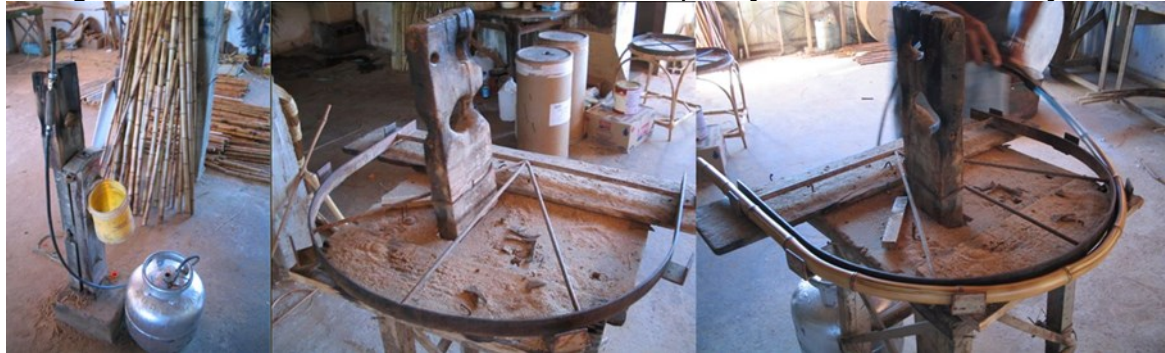
Figura 22 - Curvatura com molde de ferro - aplicação de calor com maçarico
